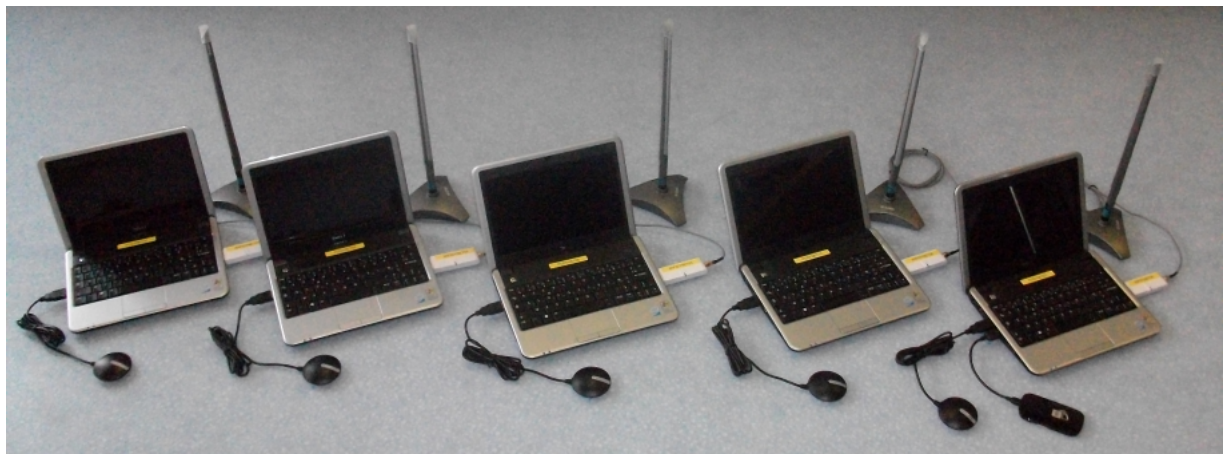
FIGURE 1.2 – La plateforme formée de Mini-dell, GPS et antennes WiFi, ainsi qu'une carte 3G.
