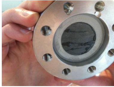
Figure 83 : Photographie de la cellule TOAR proche fissure (bleu) , montrant les microfissures à l'origine des fuites.
