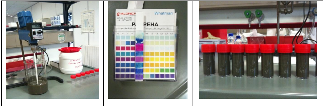
Figure 39 : Photos montrant les étapes de réalisation des cylindres de pâte de ciment OWC, et de la mesure du pH de l'eau de chaux (12,5).
