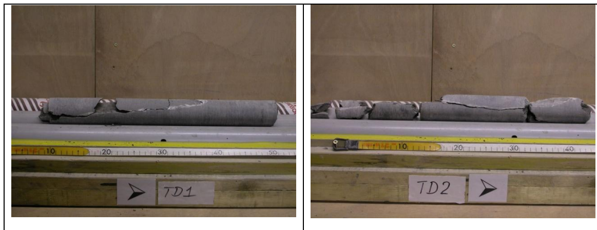
Figure 33 : Photos des carottages avortés d'une fissure remplie de calcite, forages TD1 et TD2
