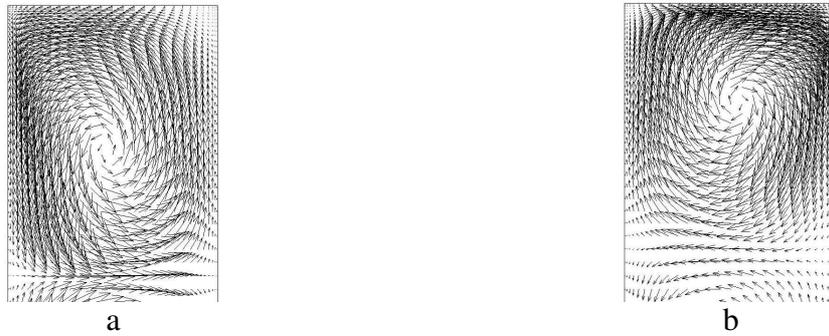
**Fig. 3-11** – Projection des vecteurs-vitesse dans le plan méridien ( $r,z$ ), près du disque supérieur, pour  $\varepsilon = 0.98$ . a)  $\Omega_D = 0$  ; b)  $\Omega_D = \Omega_i$ . L'échelle des vecteurs est identique dans les deux cas.
