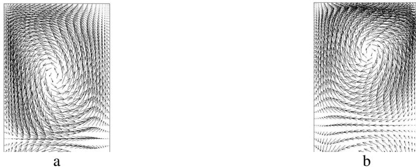
**Fig. 3-12** – Projection des vecteurs-vitesse dans le plan méridien ( $r,z$ ), près du disque supérieur, pour  $\varepsilon = 1.05$ . a)  $\Omega_D = 0$  ; b)  $\Omega_D = \Omega_i$ . L'échelle des vecteurs est identique dans les deux cas.
