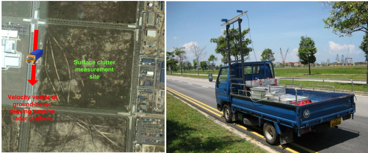
Fig. V.1: Carte des mesures du fouillis et photographie du banc de test du radar passif au sol monté sur un camion.
