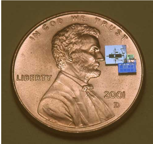
Fig. 1- 2 : Golden dust: alimentation solaire, capteurs d'accélération et de lumière
