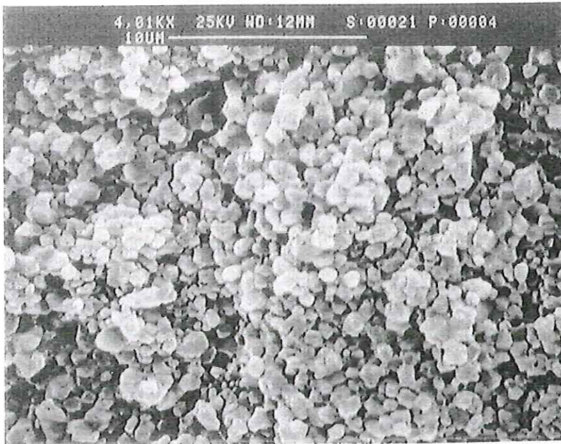
Figure 11 : Céramique d'alumine Al(C)-9.6 (CEA). Température de frittage : 1673 K. Porosité : 9.6 %.
