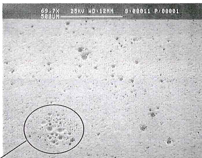
Figure 32 : Silice à bulles Si(NP)-2.2 (TSL). Porosité : 2.2 %. Grossissement : 69.7X. (non poli).
