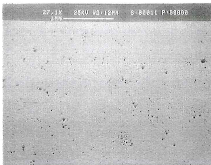
Figure 31 : Silice à bulles Si(NP)-2.2 (TSL). Porosité : 2.2 %. Grossissement : 27.1X. (non poli).
