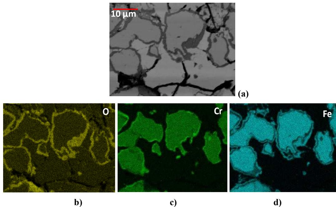
Figure 90. a) Observations au MEB du cermet B1-1 oxydé à 800 °C pendant 6 heures (a) et cartographies de l'oxygène (b), du chrome (c) et du fer (d)
