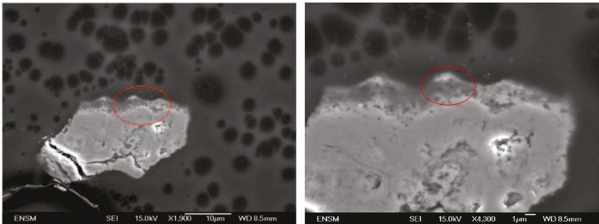
(b) Poudre 304L-T (75-100 µm) oxydée à 800 °C
