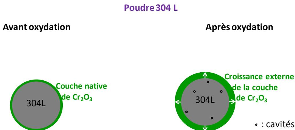
**Figure 73. Illustration de la réaction d'oxydation de la poudre d'acier inoxydable 304L (1<sup>er</sup> domaine)**
