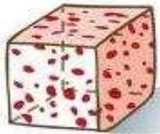
Figure 2. Les cermets: composites à particules [1]
