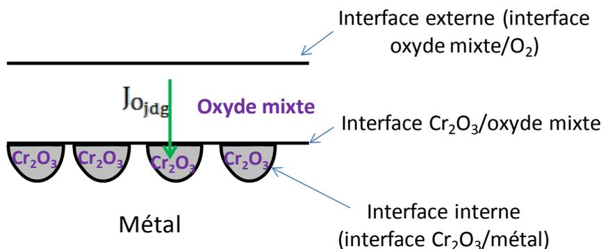
Figure 103. Schéma représentant l'oxydation interne du cermet
