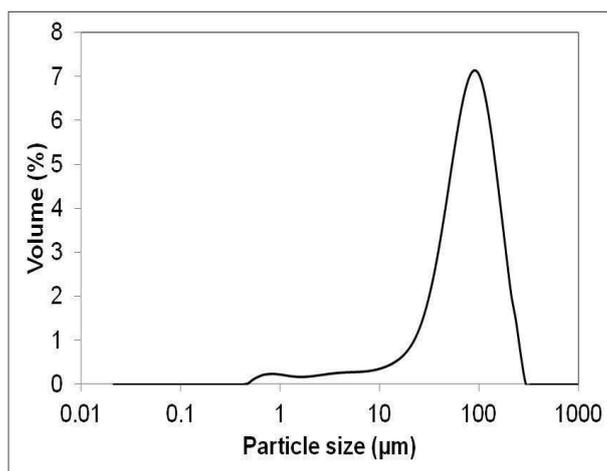
Figure 20. Granulométrie laser de la poudre 304L
