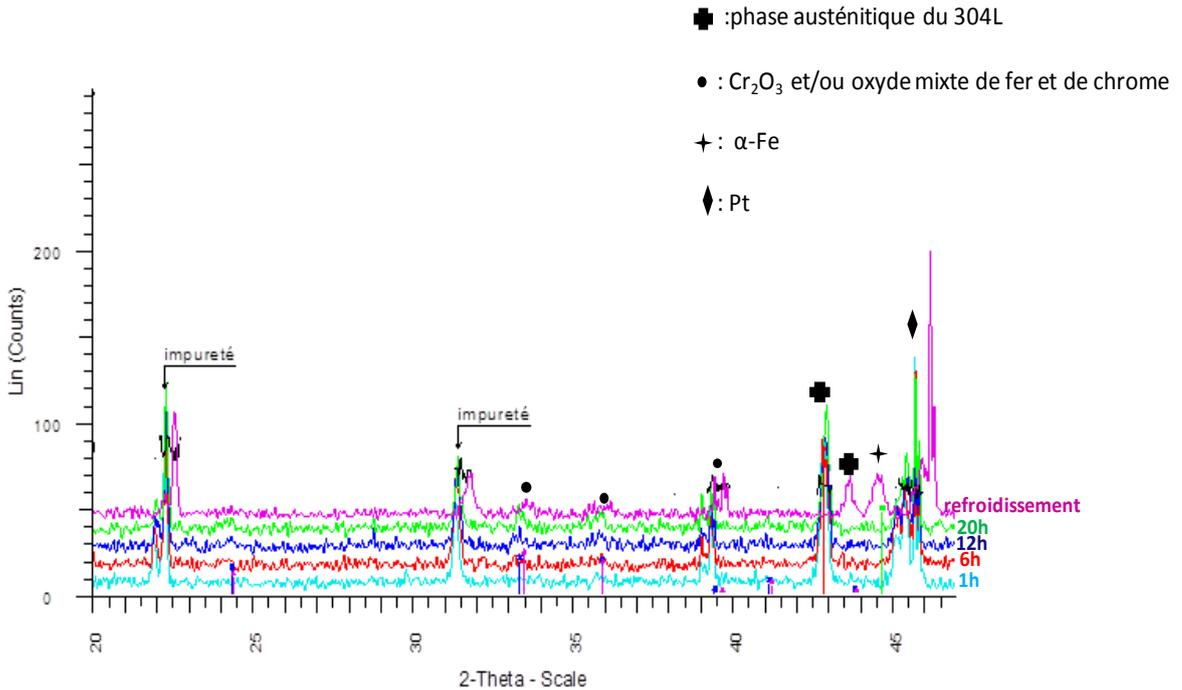
**Figure 66. Diffractogramme (DRX in situ) de la fraction 75-100  $\mu\text{m}$  de la poudre 304L après oxydation à 800°C pendant 1, 6, 12, 20 h, au refroidissement, et un diffractogramme obtenu par DRX de la poudre oxydée à 800 °C.**
