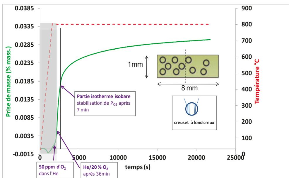
Le temps zéro correspond au moment où la prise de masse devient positive (erreur de dissymétrie de la balance). La zone grise correspond à la montée en température sous hélium (avant l'introduction de l'oxygène) et le trait vertical noir représente le début de la partie isobare.
