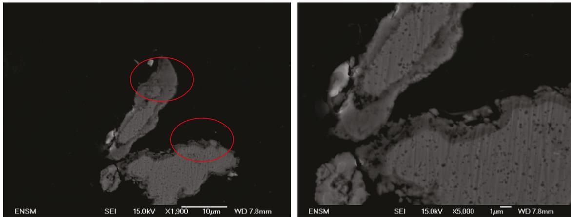
(a) Poudre 304L-T (0-50 µm) oxydée à 800 °C
