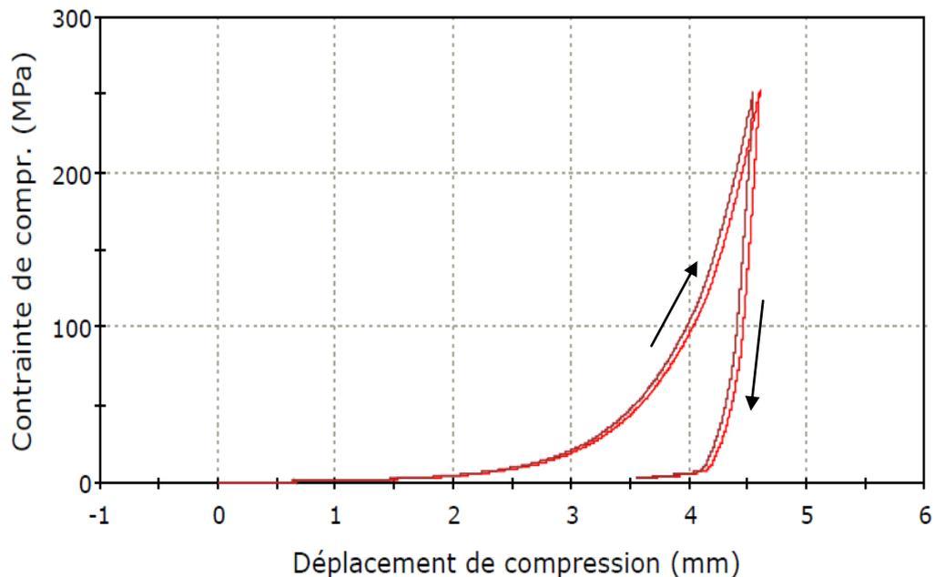
Figure 25. Courbe de compression à 250 MPa
