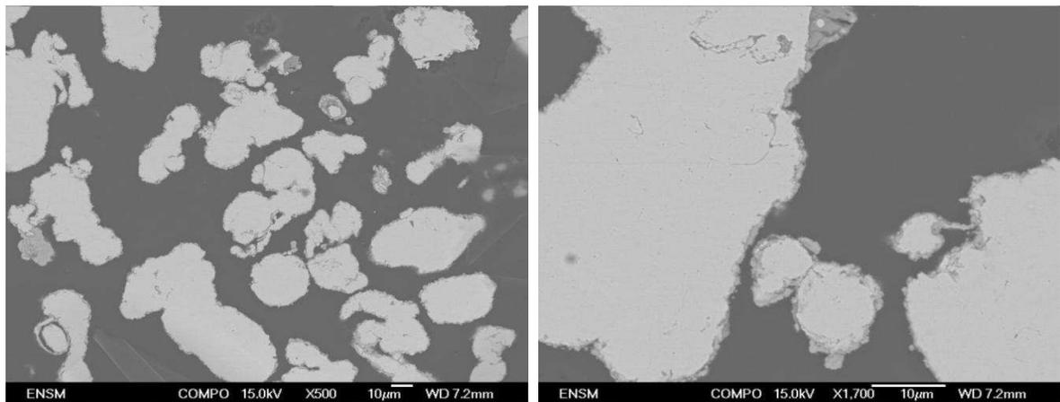
Figure 62. Poudre 304L oxydée à 800 °C pendant 6 heures
