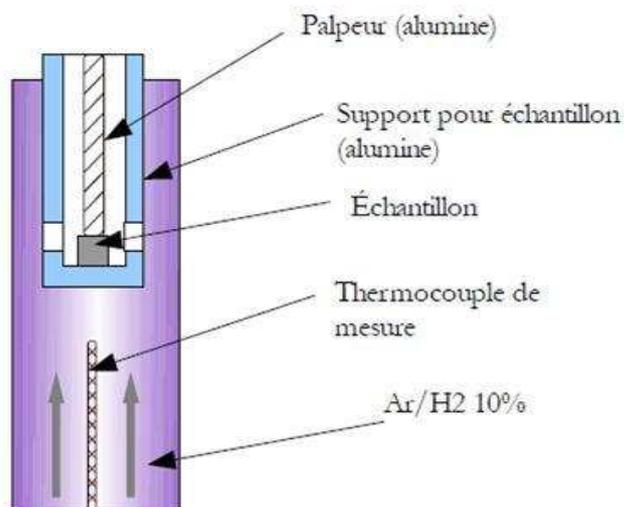
Figure 29. Schéma du principe de la mesure dilatométrique [74]
