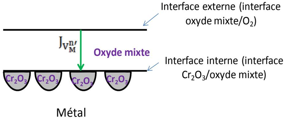
Figure 104. Schéma représentant l'oxydation externe du cermet
