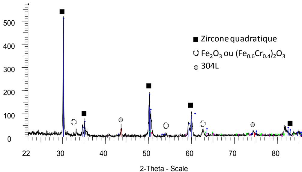
Figure 98. DRX du cermet A4 oxydé à 800 °C pendant 6 heures sous 20 % O<sub>2</sub>
