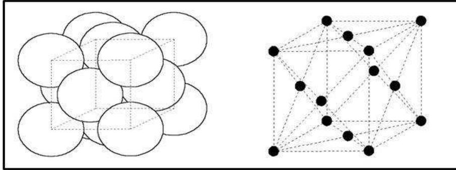
Figure 14. Phase austénitique, cubique faces centrées [52]
