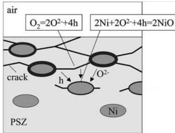
Figure 11. Schéma du mécanisme d'oxydation du composite Ni/YSZ [8].
