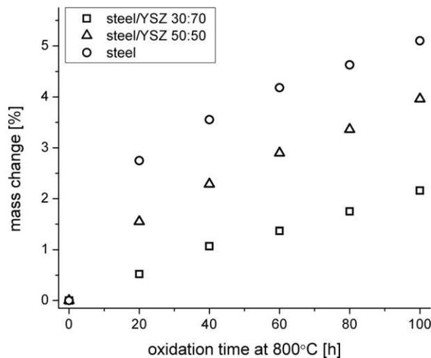
Figure 9. Variation de la masse des cermets après une oxydation cyclique à 800 °C [45].
