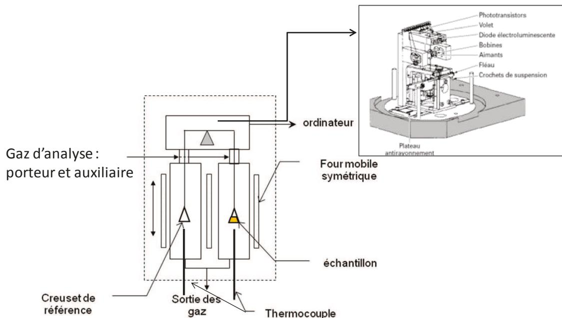
Figure 56: Schéma de la thermobalance TAG 16 de Setaram
