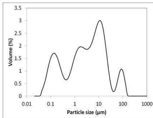
Figure 17. Distribution granulométrique de la poudre TZ-3Y-E
