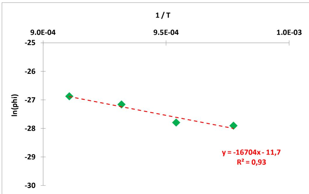
Figure 72. Variation de  $\ln \Phi$  en fonction de  $1/T$  (K<sup>-1</sup>)
