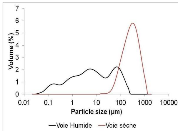
Figure 23. Granulométrie laser de la poudre du cermet
