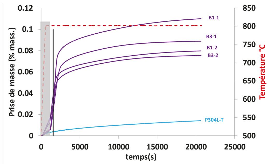
Figure 106. Comparaison des courbes de prise de masse entre la poudre 304L et les cermets oxydés à 800 °C pendant 6 heures sous 20 % O<sub>2</sub>
