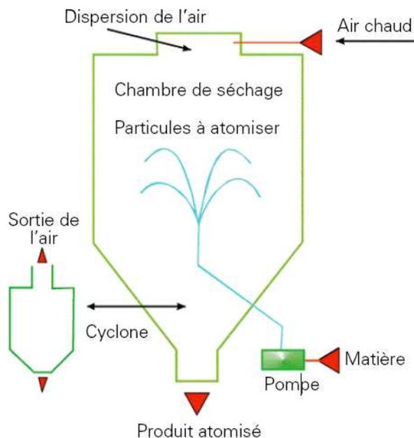
Figure 7. Schéma d'un atomiseur de poudre [24]
