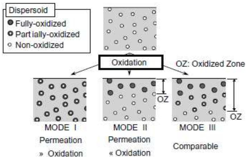
Figure 12. Schéma des modes d'oxydation des cermets [46].
