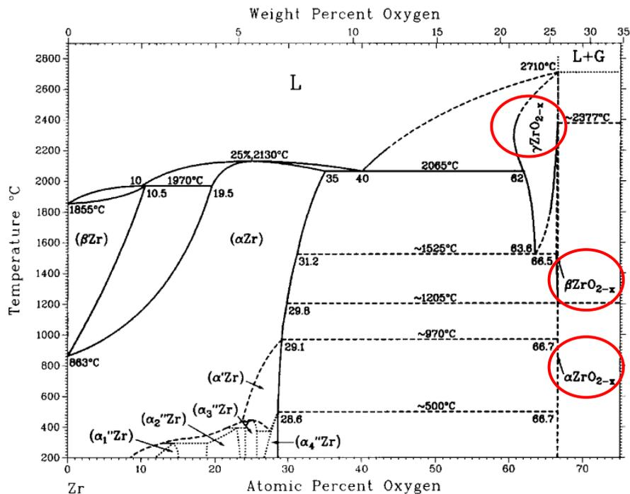
Figure 4. Diagramme de phase du système Zr-O [28].
