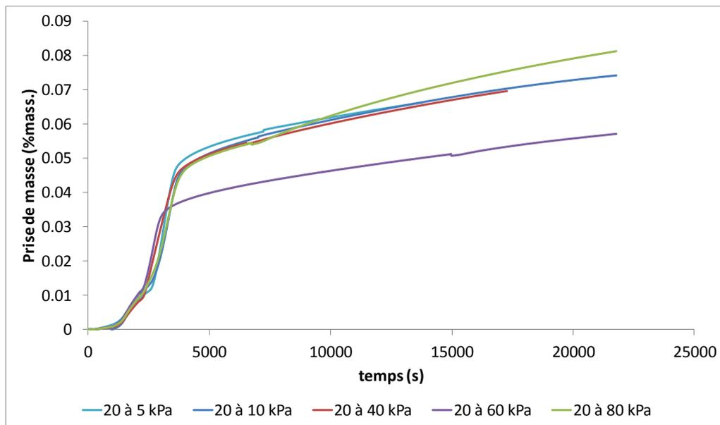
Figure 79. Courbes de prises de masse à 800 °C en fonction du temps pour les décrochements en pression partielle d'oxygène réalisés avec le cermet B6
