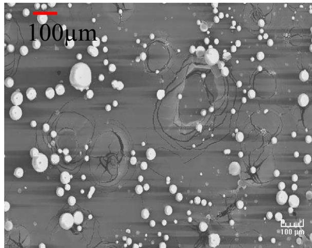
Figure 16. Observations microscopiques au MEB de la poudre TZ-3Y-E
