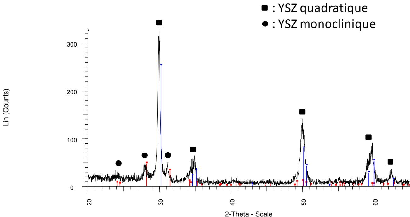
Figure 18. Diagramme de diffraction des rayons X (DRX) de la poudre TZ-3Y-E
