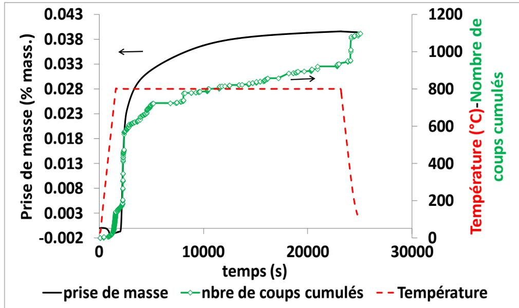
Figure 95. Thermogravimétrie associée à l'émission acoustique du cermet pendant l'oxydation sous 20% O<sub>2</sub> à 800°C.
