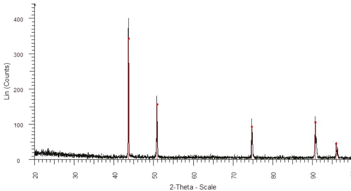
Figure 22. Analyse DRX de la poudre 304L
