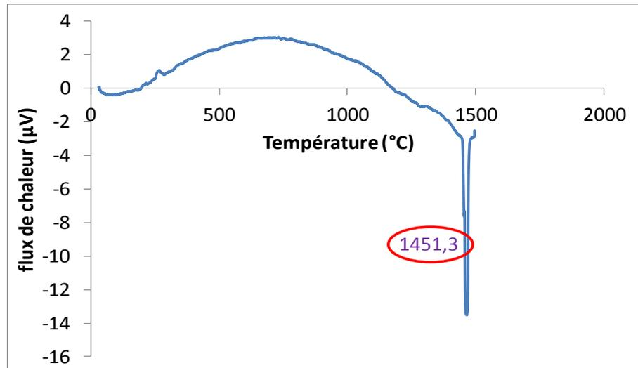
Figure 19. Analyse thermique différentielle de la poudre 304L
