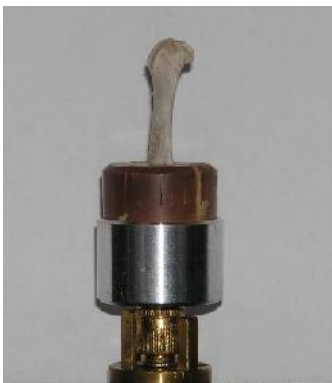
Figure 32 : Placement du fémur sur le porte échantillon pour l'acquisition avec le \mu CT.
