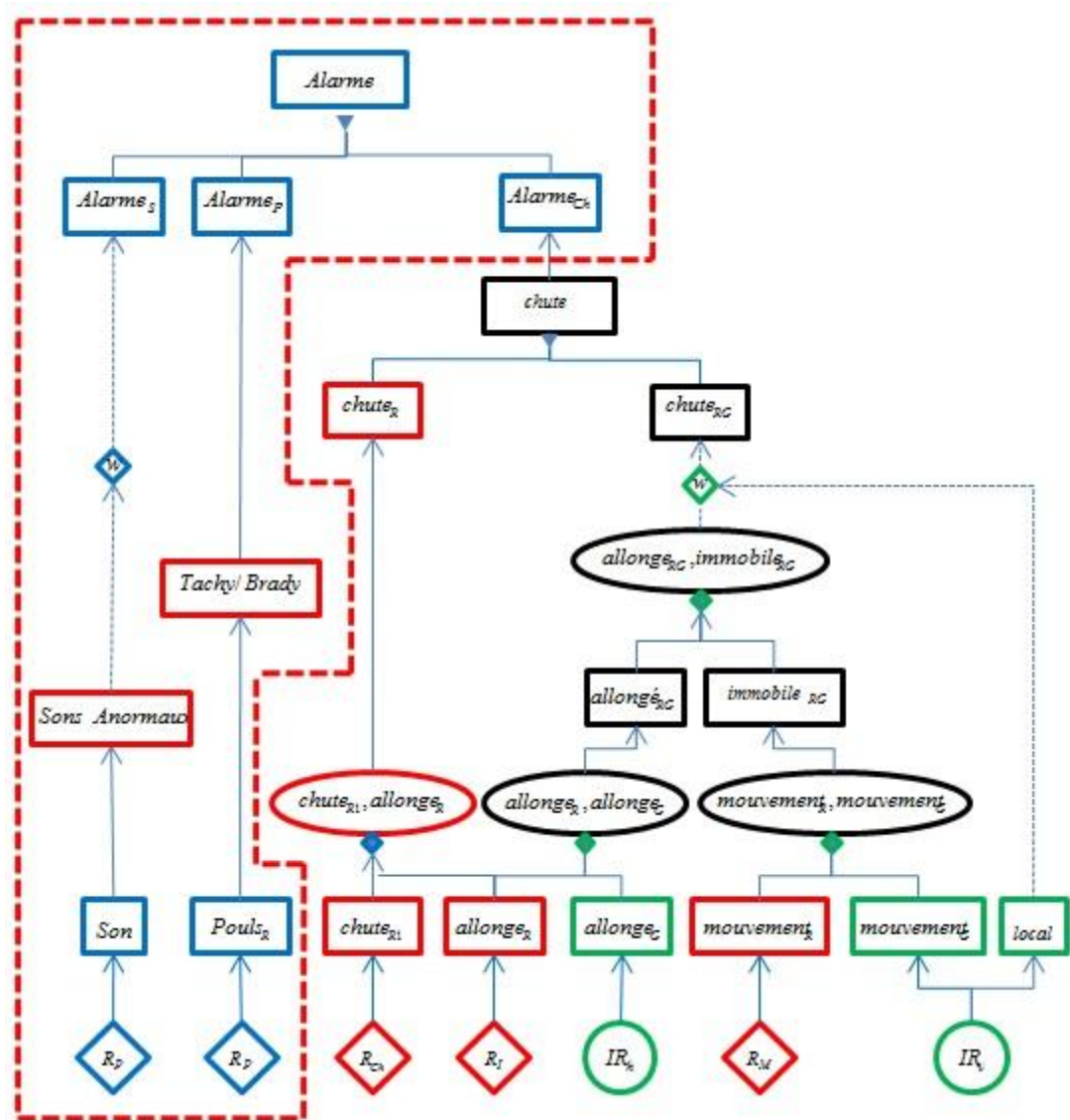
Figure 22. Extension du modèle de fusion RFPAT et GARDIEN par Réseaux Évidentiels.
