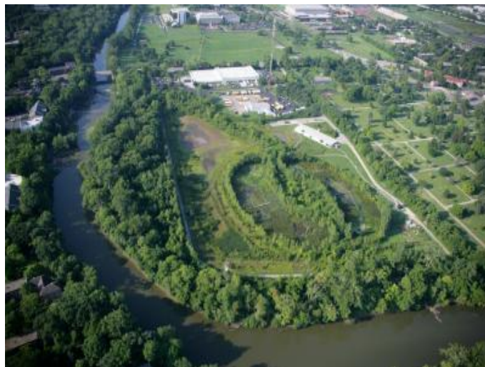
Zones humides artificielles (État-Unis) rétenion N = 43 % (Mitsch et al, 2005)
