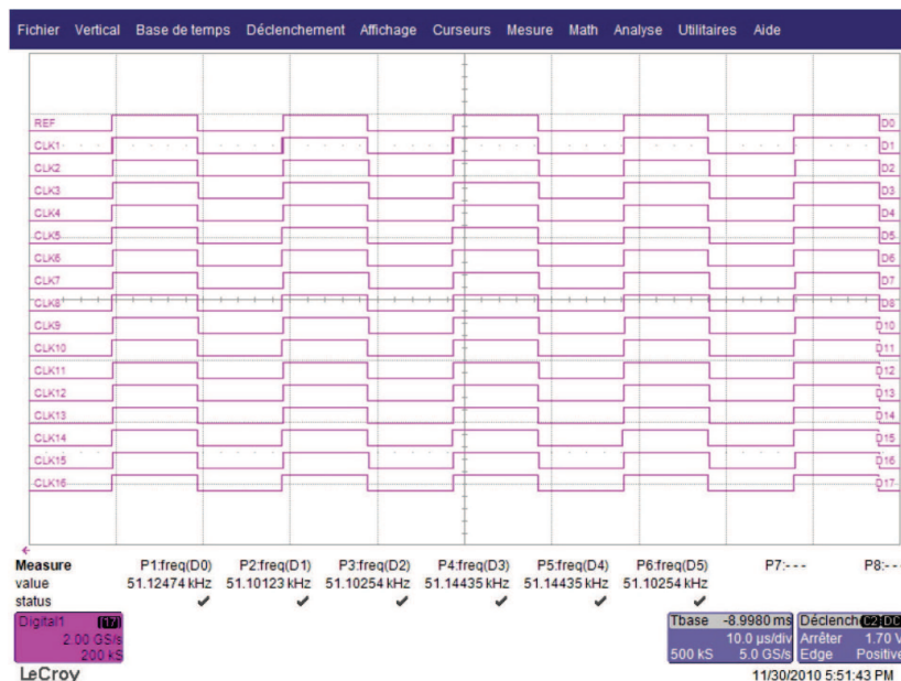
Fig. 5.13 – Signaux de sortie d'un réseau de 16 SS-ADPLLs, on n'observe pas de modelock (configuration : bidirectionnelle, fréquences centrales identiques).
