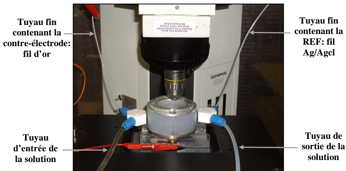
Figure II.2 : Montage avec cellule électrochimique fermée
