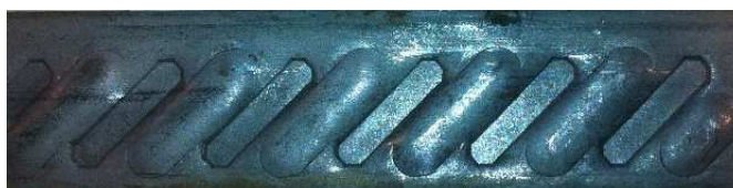
FIGURE 3.9 – Acier plat cranté artisanal de la première campagne d'essai de tirant ( 25 \times 3,5 \text{ mm}^2 )
