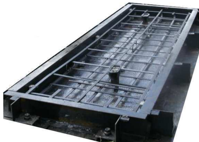
FIGURE 4.4 – Ferrailage en acier plat de l'essai de poutre-dalle
