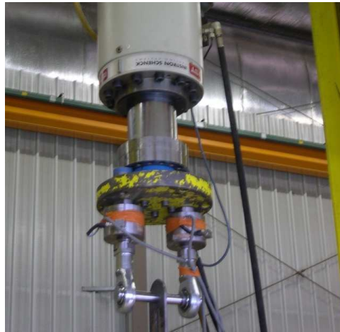
FIGURE 3.14 – Vérin Schenck équipé de capteurs de force
