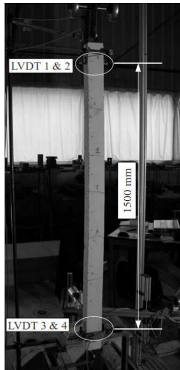
FIGURE 3.16 – Tirant HA à 170 x 10 x 10 cm renforcé par acier plat
