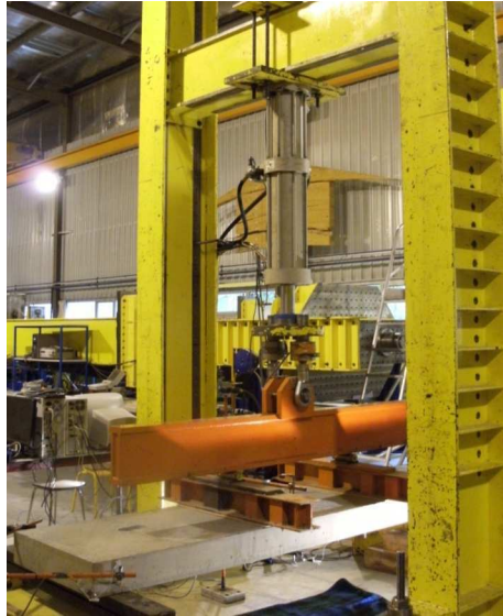
FIGURE 4.5 – Vue globale de l'essai poutre-dalle en flexion 4 points
