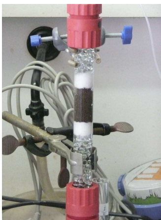
Figure 21: Représentation d'une colonne constituée des cinq couches
