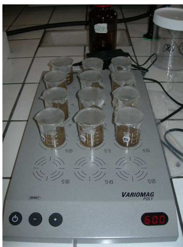
Figure 15: Illustration de la table multiagitation lors d'une expérience d'adsorption/lixiviation en batch agité
