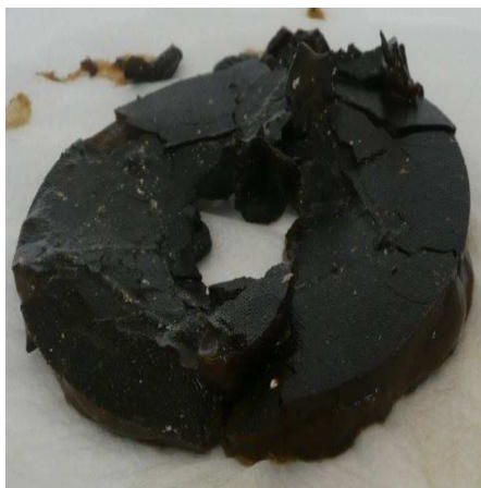
Figure 87: Gâteau de boue réalisé avec le filtre presse
