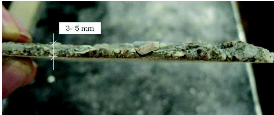
FIGURE 1.8: Épaisseur de l'écaillage du béton B60 et exposé au feu ISO [Mindeguia 09]
