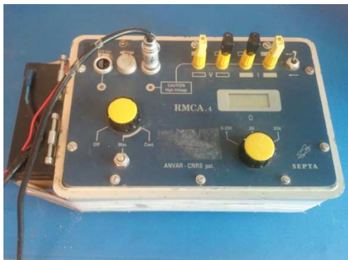
Figure II-9 : Résistivimètre RMCA-4 (CNRS).
