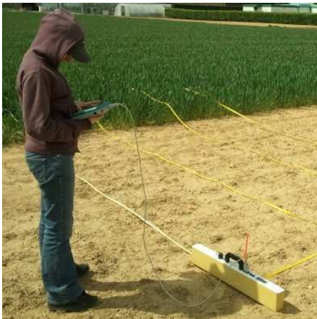
Figure III-29 : CS60 relié à sa console de commande.
