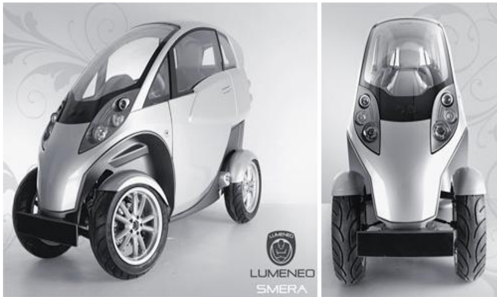
Figure 2. 3 : La Smera, véhicule inclinable en cours de développement par la société lumeneo
