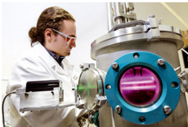
FIGURE 1.16 – Réacteur PAMPRE, dans lequel les tholins utilisés au cours de mon travail de thèse ont été produits. On remarquera la couleur rose du plasma, liée au gaz majoritaire dans le mélange, l'azote (photographie LATMOS).
