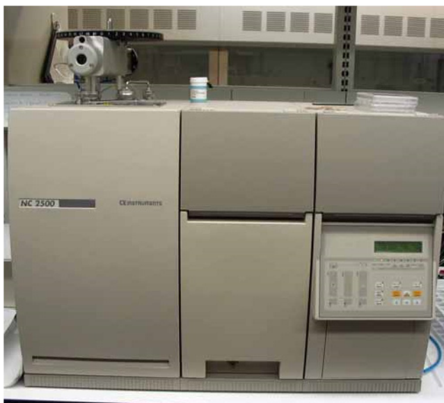
FIGURE 2.23 – Instrument utilisé pour réaliser les dosages élémentaires sur les résidus de chauffe ainsi que les matériaux modèles initiaux. Il s’agit d’un analyseur élémentaire NC 2500 de CE Instruments.
