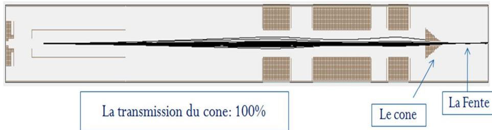
Fig.VI. 23: Simulation numérique de la transmission des ions à travers une conductance conique placée entre le triplet d'injection et le HRS.
