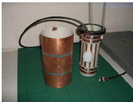
Figure 4-9 : photographie de l'antenne birdcage (à droite) sortie de son écran radiofréquence (à gauche).
