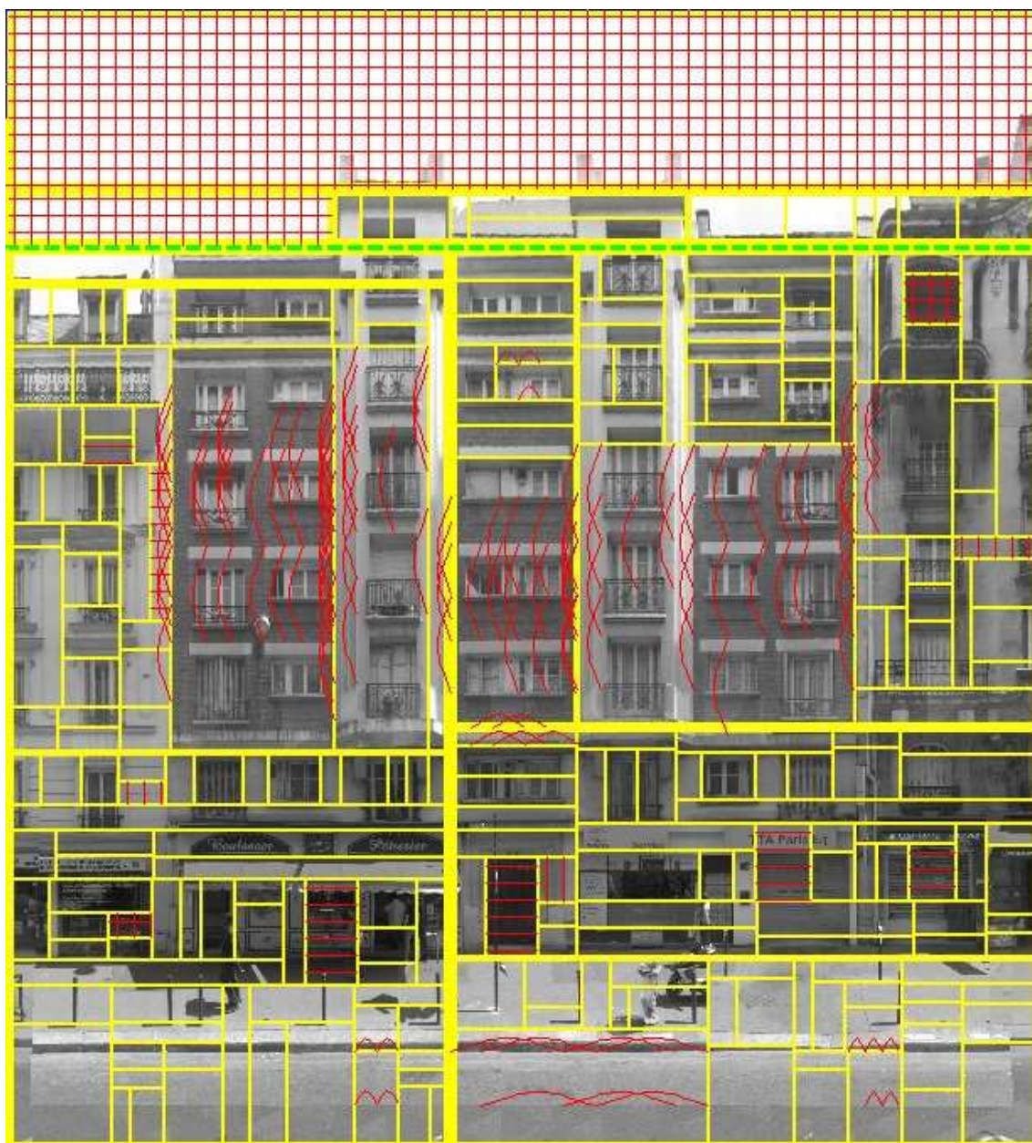
FIGURE 3.25 – Segmentation hiérarchique. Découpes en jaune. Modèles en rouge.
