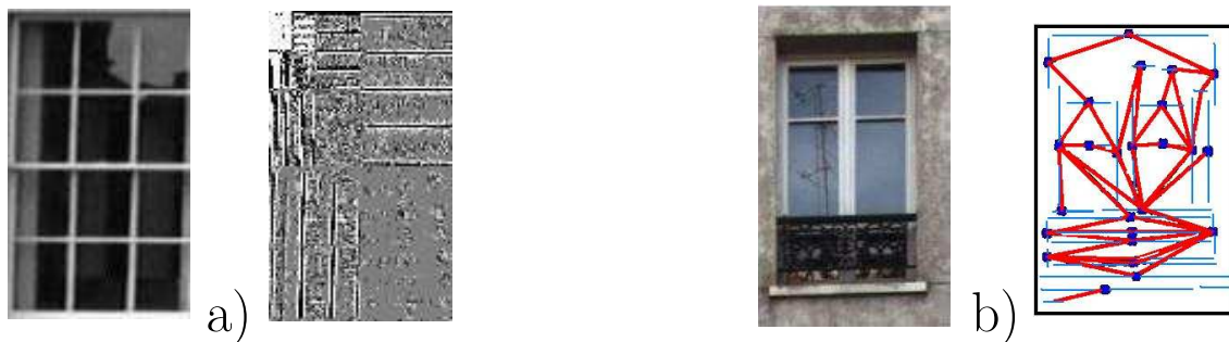
FIGURE 2.5 – Deux caractéristiques de l'apparence d'une fenêtre : a) Représentation de la texture par ondelettes de Haar (Dick et al. [2004]) ; b) Représentation de la géométrie par graphe de contours (Haugeard et Philipp-Foliguet [2010]).
