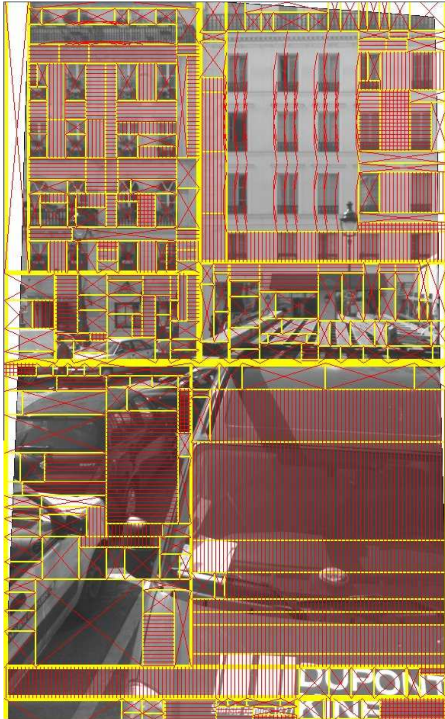
FIGURE 3.16 – Résultat de segmentation hiérarchique : la façade est d’abord séparée de la rue, puis de sa voisine. Découpes en jaune (épaisseur du trait fonction de la profondeur de la segmentation). Modèles planaires : quadrillages rouges. Modèles cylindriques : bandes rouges. Périodes : arcs rouges. Régions trop petites : croix rouges.
