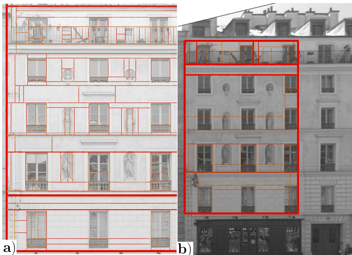
FIGURE 3.19 – Segmentation hiérarchique d'une façade acquise de deux différents points de vue et de différents appareils. a) Segmentation d'un partie de la façade présentée sur la figure 3.18. b) Segmentation de la même façade acquise d'un point de vue plus proche de telle sorte que seule la partie gauche est visible.
