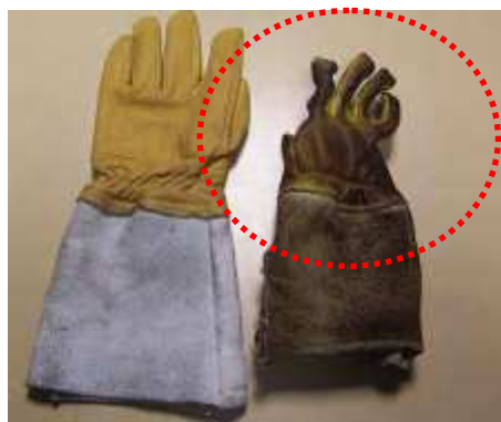
Figure 3.23 : Gant en cuir, avant et après le flash thermique (Photo BSPP)
