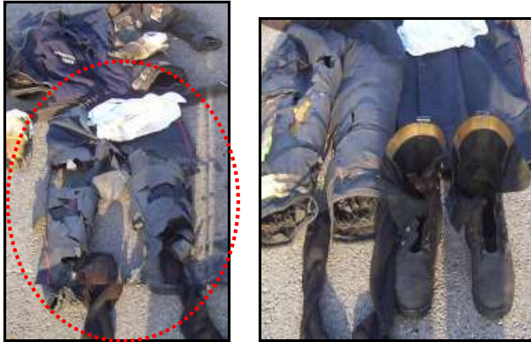
Figure 3.24 : Equipement E1 après le flash thermique (test n°1) (Photo BSPP)
