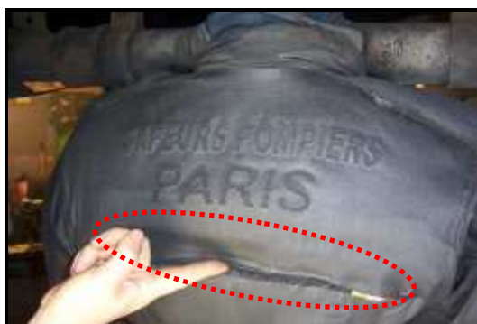
Figure 3.27 : Destruction du marquage et des coutures (Photo BSPP)
