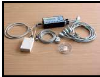
Figure 4.10: Sondes de température (photo CEB)
