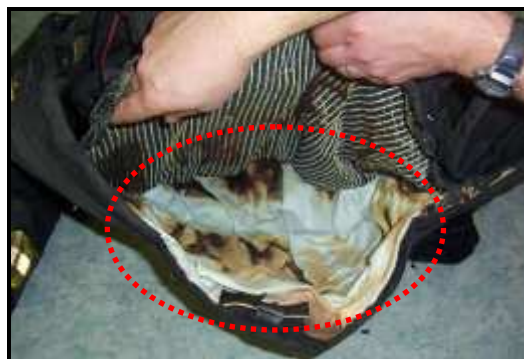
Figure 3.27 : Destruction du marquage et des coutures (Photo BSPP)
