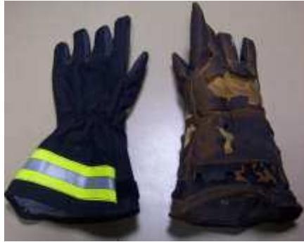
Figure 3.31 : Gant en textile avant et après le flash thermique (Photo BSPP)
