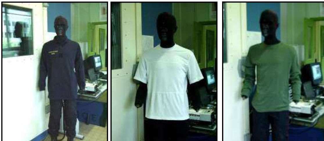
Figure 2.7 : Mannequin équipé d'un polo F1 ML de référence (à gauche), d'un échantillon MC (au centre), d'un échantillon ML (à droite) (Photos CEB)
