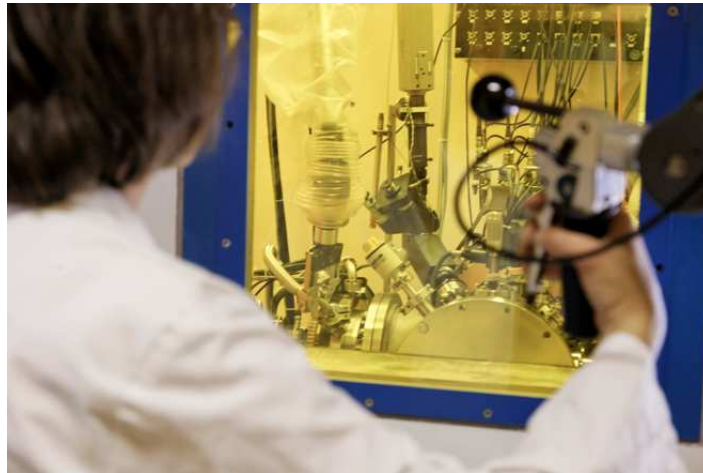
FIGURE 3.2: Vue de la chambre d'analyse CASIMIR destinée à accueillir des échantillons fortement radioactifs
