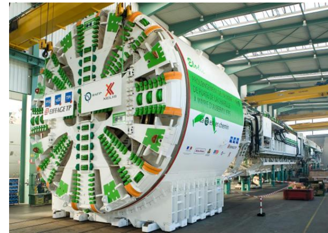
Tunnelier à pression de terre utilisé lors du prolongement de la ligne 12 du métro parisien.
