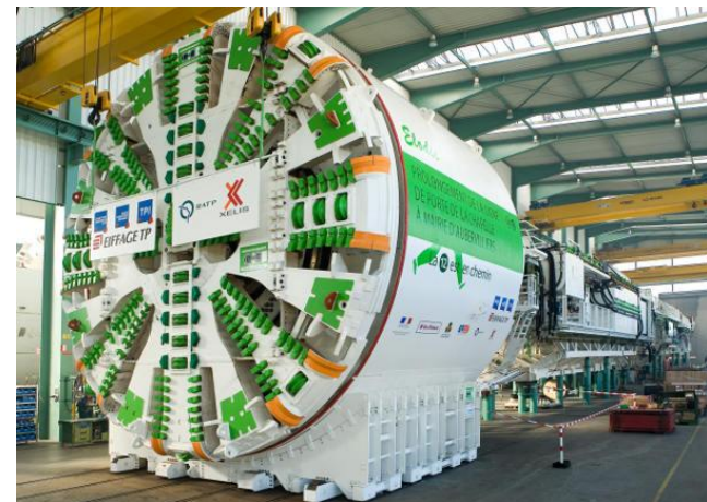
Roue de coupe du tunnelier utilisé lors du prolongement de la ligne 12 du métro parisien (taux d'ouverture = 50%)
