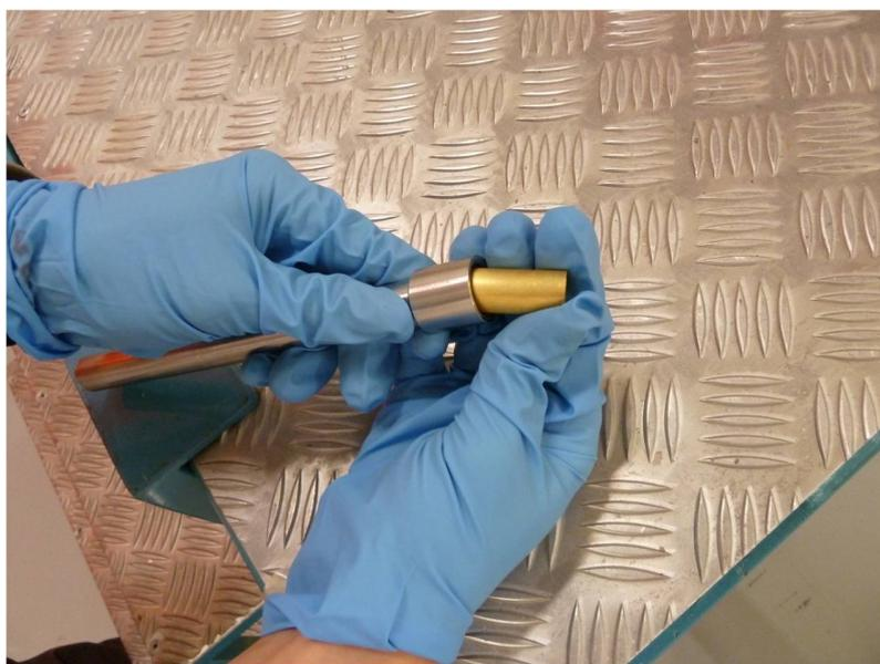
FIGURE 6.2 – Insertion d'un échantillon d'or dans le porte-échantillon
