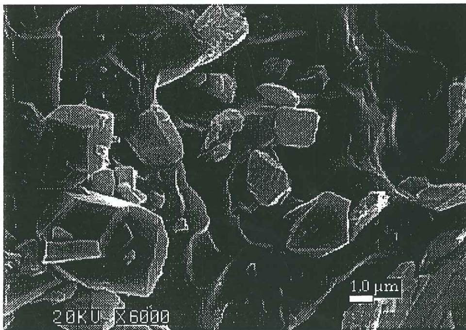
Photo 2 : microcristaux de plagioclases et de pyroxènes enchassés dans du verre résiduel après dissolution dans HF1% d'une scorie broyée (Lv)
