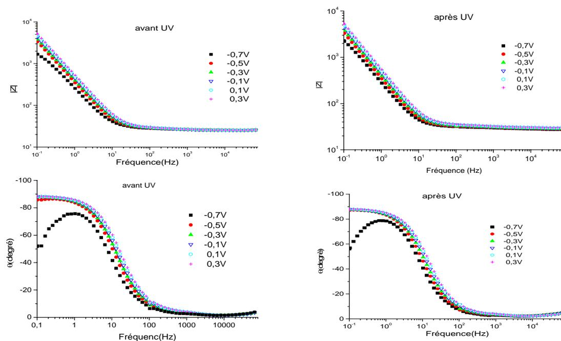
**Figure 6.1.** Diagrammes d'impédance à l'obscurité de l'échantillon  $TiO_2$ -NT(TB)20V45min en milieu NaOH (pH=12,5) avant et après éclaircissement UV en représentations de Bode
