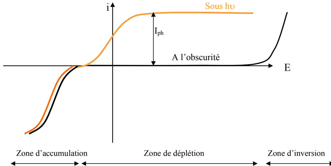
**Figure 1.4:** Courbe  $I = f(E)$  à l'obscurité et sous éclairage pour un semiconducteur de type n
