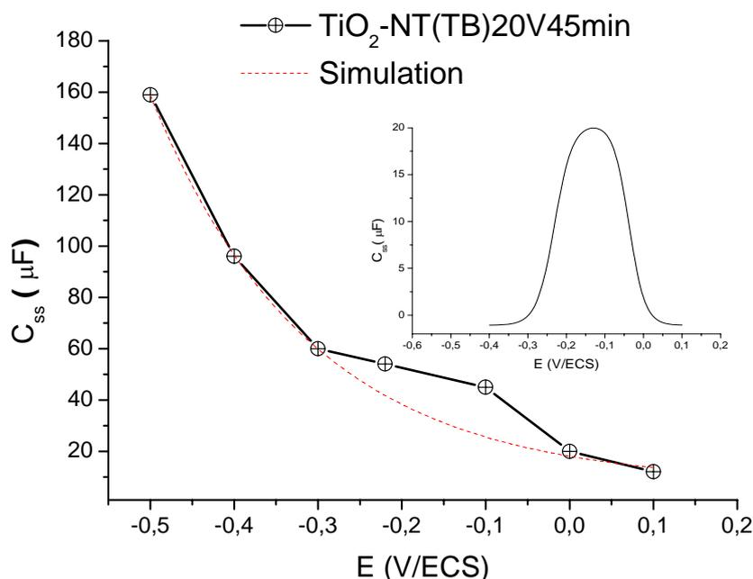
**Figure 5.9** Capacité d'état de surface  $C_{ss}$  déterminé en utilisant le circuit équivalent de la figure 5.5.a pour la couche  $\text{TiO}_2\text{-NT(TB) 20V45min}$ . Comparaison entre les résultats expérimentaux et la courbe simulée. Encart : amplification dans le domaine de potentiel [-0,4V - +0,1V]
