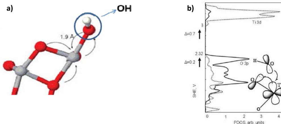
**Figure 1.15** a) Adsorption de OH sur 5c-Ti b) Diagramme de DOS pour OH adsorbé sur TiO<sub>2</sub> (Extrait de [34])
