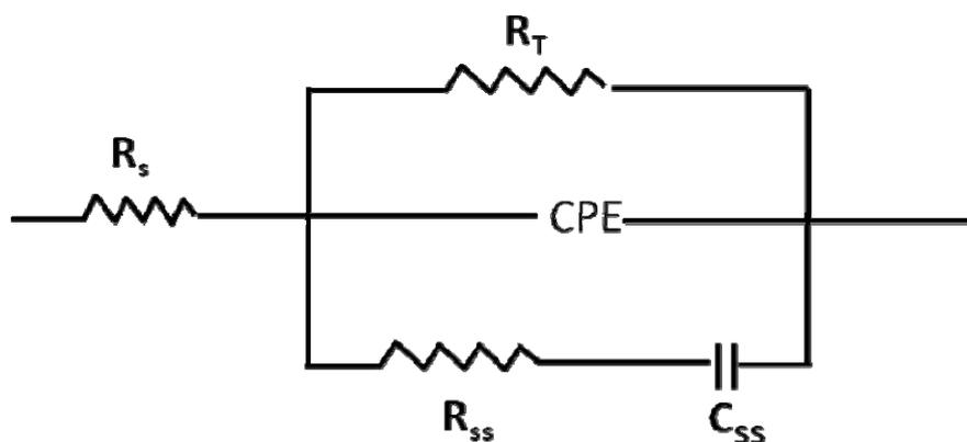
**Figure 5.11** Circuit électronique équivalent avant et après exposition UV pour la couche  $\text{TiO}_2\text{-NT(EG)20V45min}$
