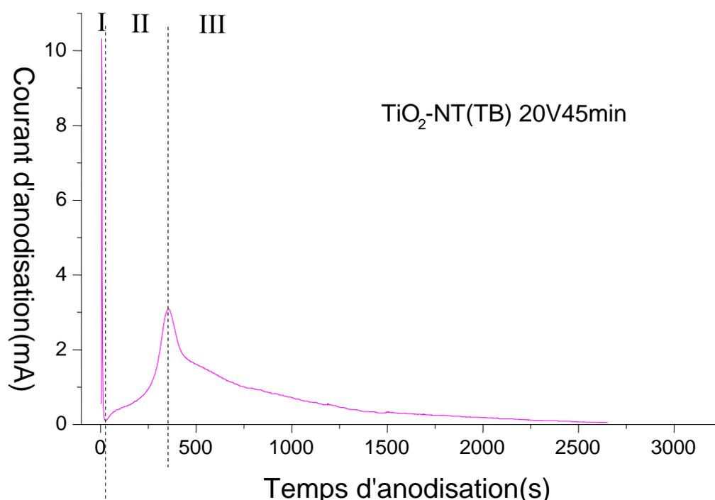
**Figure 3.8** Variation du courant en fonction de temps pendant l'anodisation de TiO<sub>2</sub>-NT(TB) 20V45min
