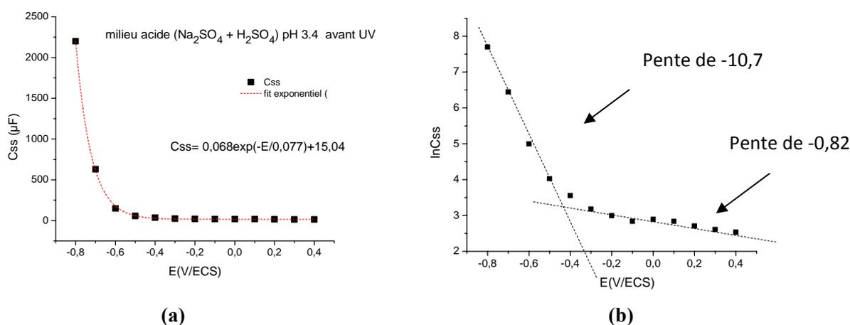
**Figure 6.12** Capacité de l'état de surface(a) et  $\ln(C_{ss})$  en fonction de potentiel appliqué(b) de la couche  $TiO_2-NT(TB)20V45min$  dans le milieu  $Na_2SO_4 + H_2SO_4$  (pH=3,5) à l'obscurité avant éclaircissement UV
