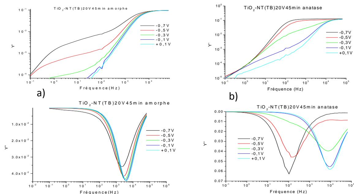
**Figure 5.2** Diagrammes d'admittance de l'échantillon  $\text{TiO}_2\text{-NT(TB)20V45min}$  amorphe(a) et  $\text{TiO}_2\text{-NT(TB)20V45min}$  anatase(b) ( $Y'$  :partie réelle,  $Y''$  :partie imaginaire)
