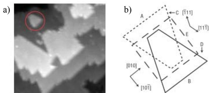
**Figure 1.11** a) Cliché de STM de marches monoatomique sur le plan (101) de A-TiO<sub>2</sub> b) schéma montrant les différents types de marches (de A à E) (Extrait de [32])
