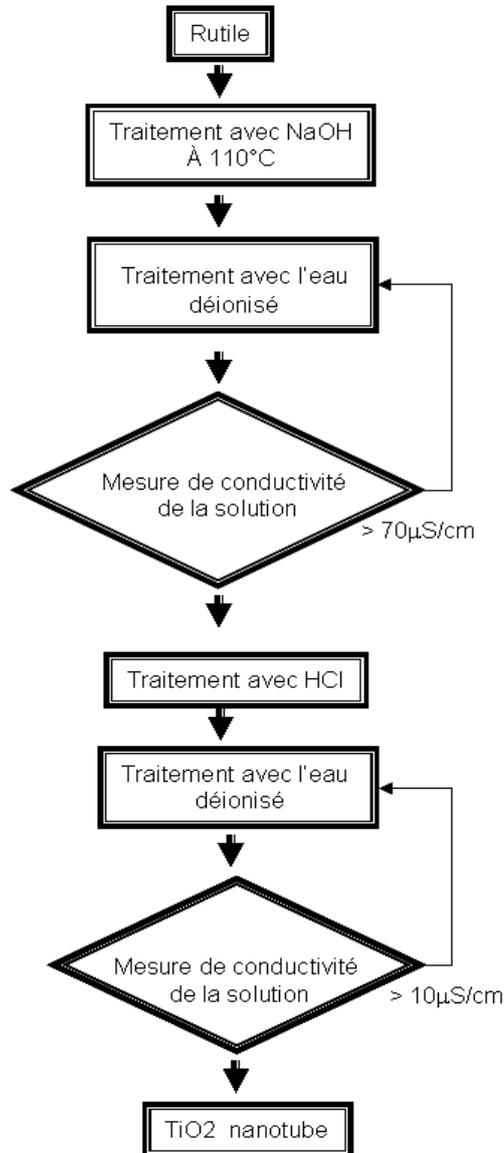
**Figure 3.3** Schéma de formation de nanotube de TiO<sub>2</sub> par un processus hydrothermal alcalin
