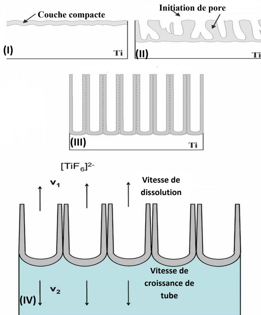
**Figure 3.5** Mécanisme de formation de nanotubes de TiO<sub>2</sub> selon réf. [33]
