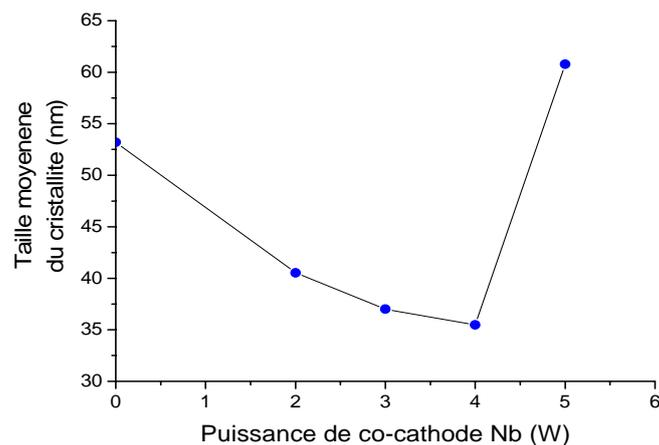
**Figure 2.12** Variation de la taille des cristallites en fonction de la puissance appliquée sur la co-cathode en niobium
