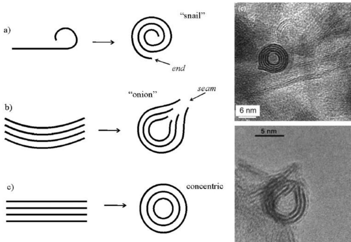
**Figure 3.4** Structures intermédiaires à partir de feuillets, pendant la formation de tube de TiO<sub>2</sub> par la voie hydrothermale
