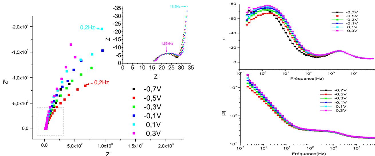
**Figure 7.3** Diagrammes d'impédance sous exposition UV de l'échantillon  $TiO_2$ -NT(TB)20V45min en milieu NaOH (pH=12,5), en représentation de Nyquist et de Bode. L'insert est la représentation de Nyquist à basse fréquence.
