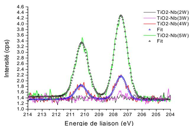
**Figure 2.8** Spectres XPS de Nb<sub>3d</sub> de dépôts TiO<sub>2</sub> dopé niobium
