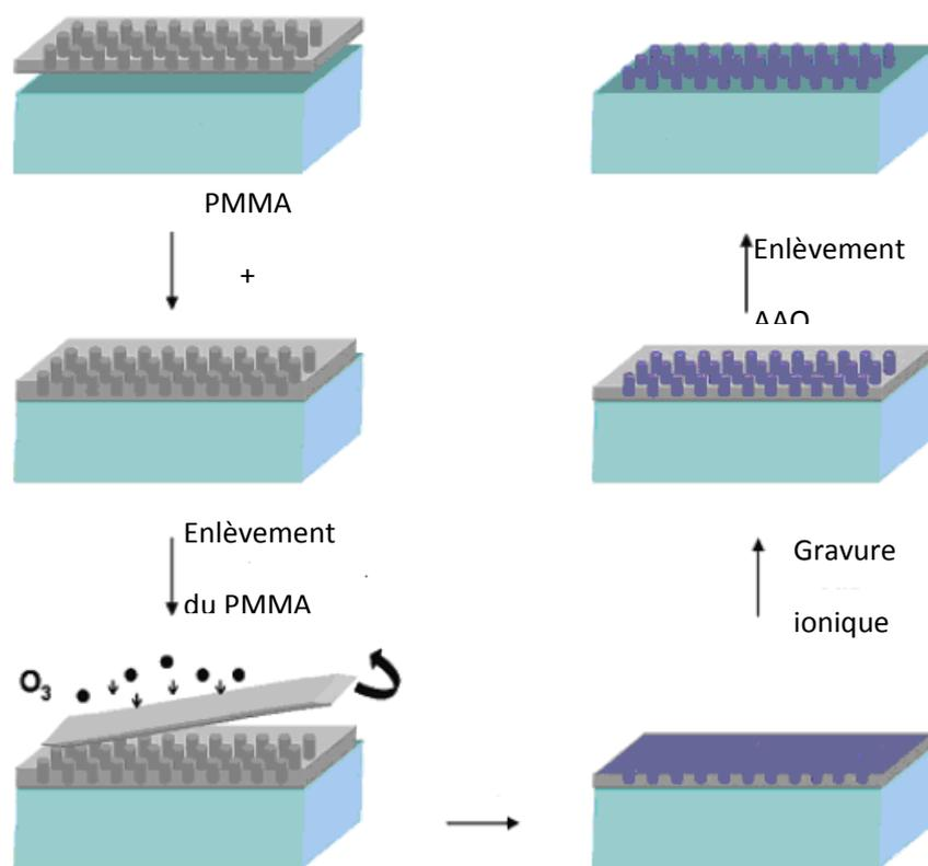
**Figure 3.1:** Schéma du procédé de synthèse de nanotubes de TiO<sub>2</sub> à l'aide d'une membrane d'oxyde d'aluminium AAO.
