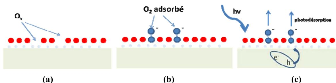
**Figure 1.9** a) O<sub>v</sub> à la surface de TiO<sub>2</sub> b) O<sub>2</sub> adsorbé sur un site d'O<sub>v</sub> c) photodésorption de O<sub>2</sub>
