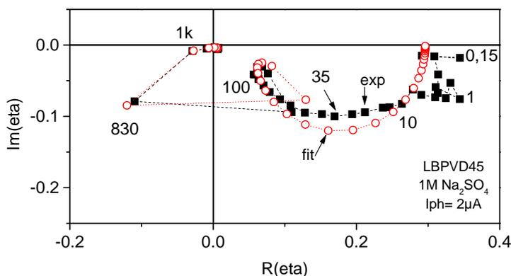
**Figure 7.13 :** Diagramme IMPS (9 points/décade) d'une couche  $TiO_2$  compacte au contact d'une solution 1M  $Na_2SO_4$  polarisée à +0,4 V/(Ag/AgCl) ; photocourant = 2  $\mu A$  sous éclairage d'une lampe Xénon 150W ; flux de photons  $\approx 10^{14} \text{ cm}^{-2} \text{ s}^{-1}$ .
