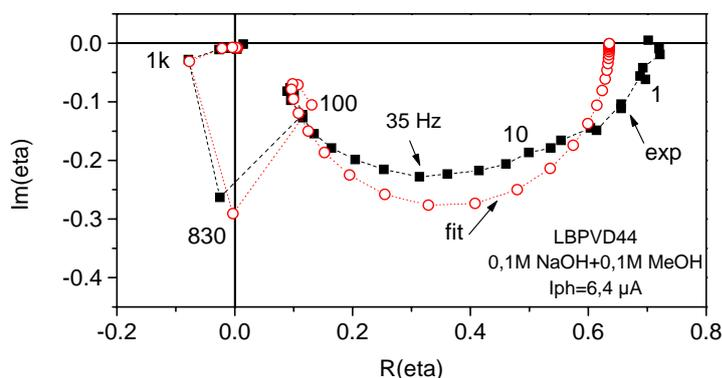
**Figure 7.12 :** Diagramme IMPS (9 points/décade) d'une couche  $TiO_2$  compacte au contact d'une solution 0,1M NaOH + 0,1M MeOH polarisée à +0,4 V/(Ag/AgCl) ; photocourant = 6,4  $\mu A$  sous éclairage d'une lampe Xénon 150W ; flux de photons  $\approx 10^{14} \text{ cm}^{-2} \text{ s}^{-1}$ .
