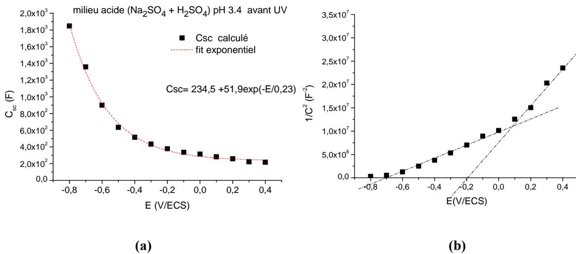
**Figure 6.11** Capacité de zone de charge d'espace calculée (a) et digramme de Mott-Schottky (b) de la couche  $TiO_2-NT(TB)20V45min$  dans le milieu  $Na_2SO_4+H_2SO_4(pH=3,5)$  à l'obscurité avant éclaircissement UV.
