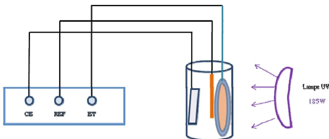
**Figure 5.1** Schéma de montage de mesure d'impédance
