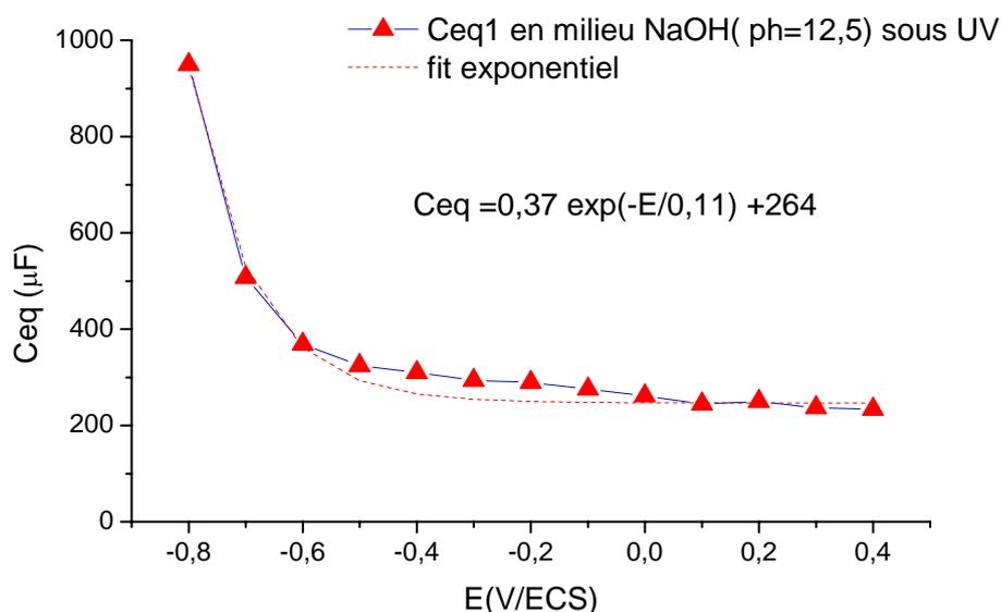
**Figure 7.4** Variation de la capacité équivalente ( $C_{eq1}$ ) sous éclairage dans NaOH et simulation de sa décroissance exponentielle en fonction du potentiel
