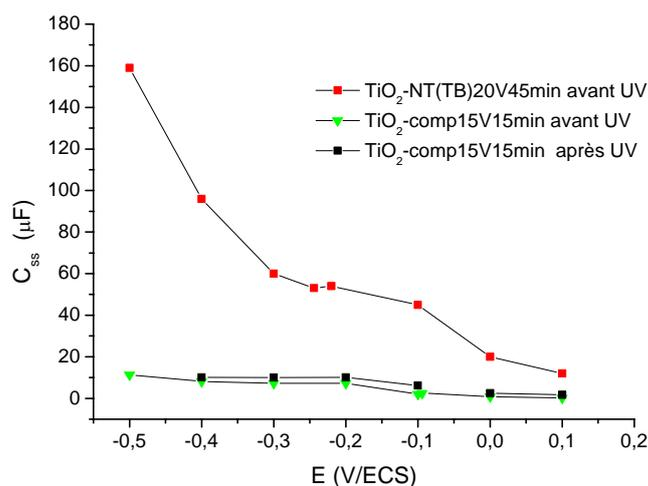
**Figure 5.8:** Variation des capacités  $C_{ss}$  des états de surface en fonction du potentiel appliqué en utilisant le modèle de la figure 5.5 avant et après exposition UV
