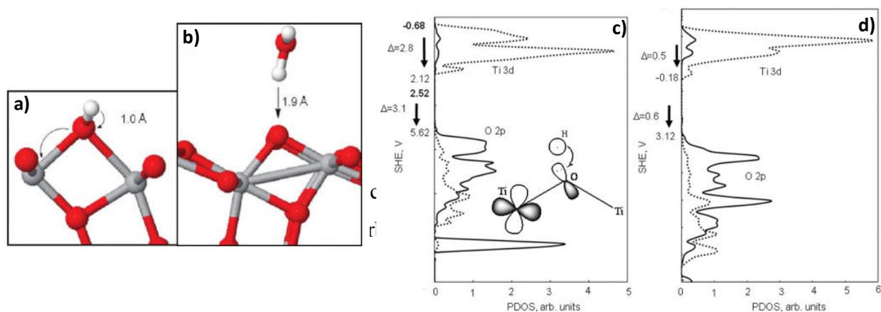
**Figure 1.14** a) H adsorbé sur 2c-O, b) H<sub>2</sub>O adsorbé sur 2c-O, c) Diagramme DOS de TiO<sub>2</sub> en présence de H adsorbé, d) Diagramme DOS de TiO<sub>2</sub> en présence de H<sub>2</sub>O adsorbé (Extrait de [34])
