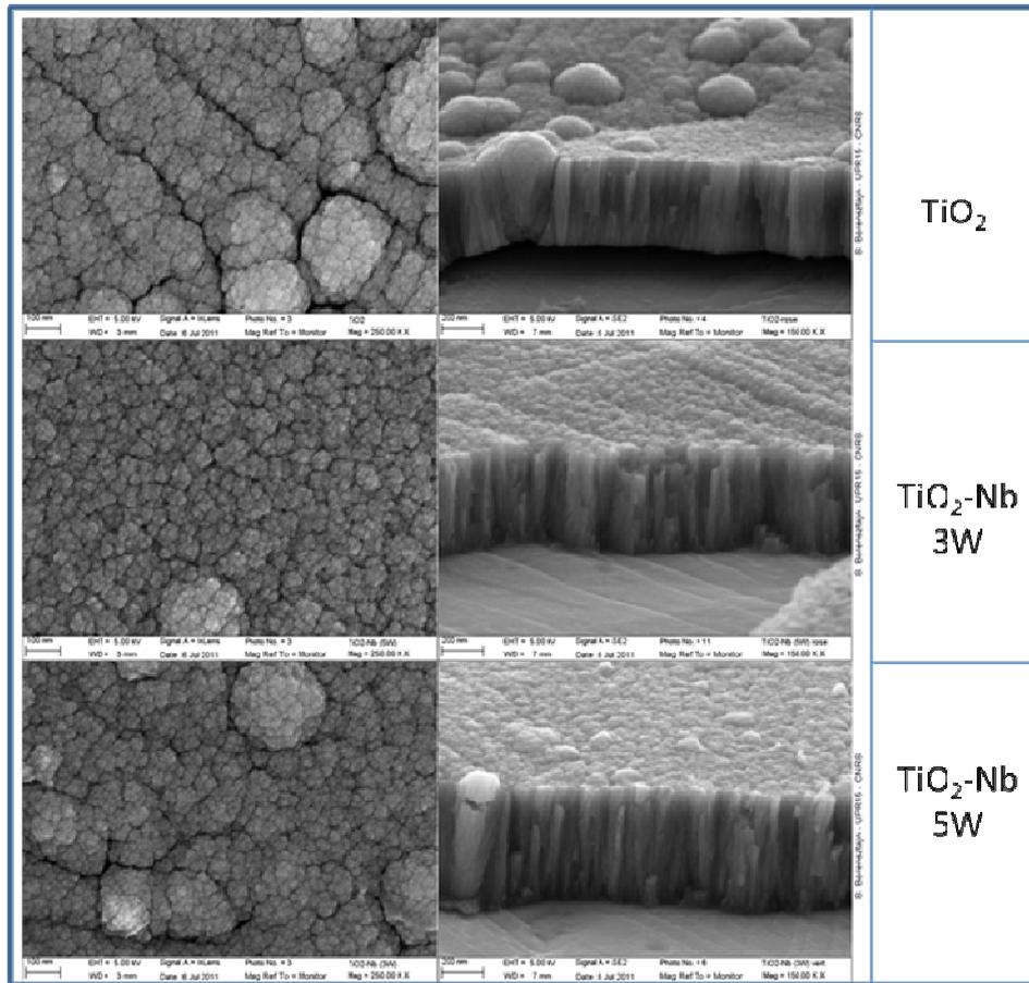
**Figure 2.3** Clichés MEB-FEG d'échantillons de TiO<sub>2</sub> non dopés et TiO<sub>2</sub> dopés Nb(3Wet 5W)
