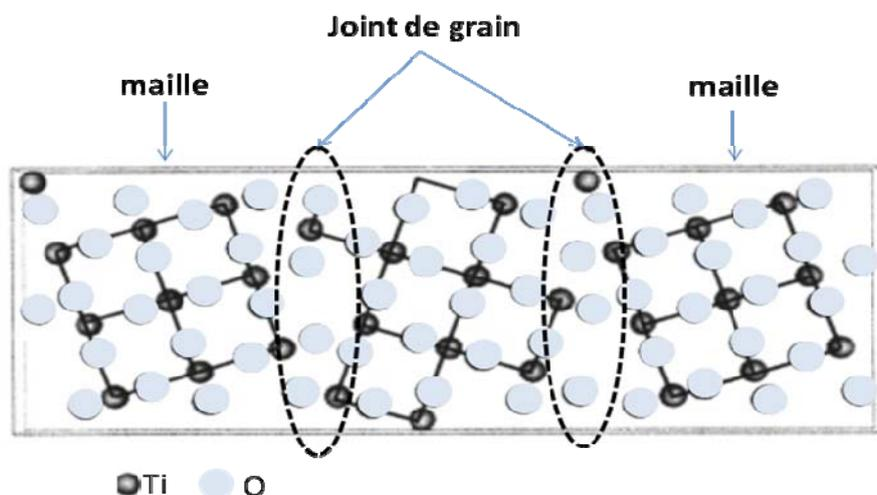
**Figure 1.19** Schéma de joints de grain dans des mailles de TiO<sub>2</sub> cristallin (vue sur le plan (001))
