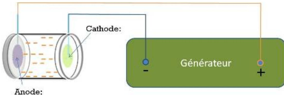
**Figure 3.6** Montage d'anodisation du titane
