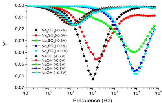
**Figure 6.6** Diagramme d'admittance à l'obscurité avant éclaircissement dans  $Na_2SO_4$  et NaOH
