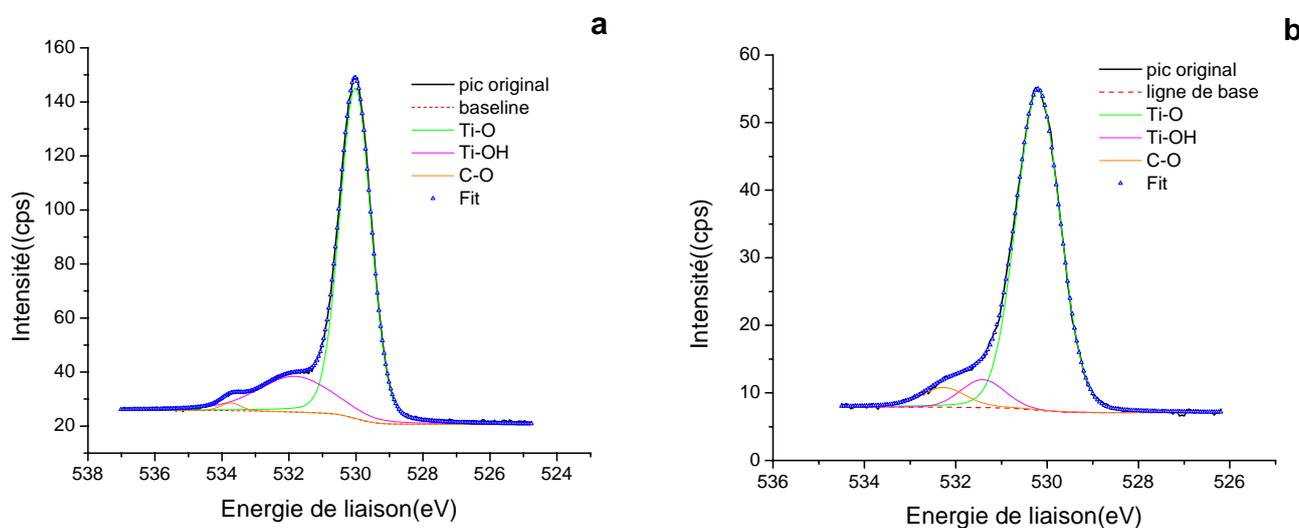
**Figure 2.7** Déconvolution du pic d'O1s pour TiO<sub>2</sub> non dopé (a) et TiO<sub>2</sub>-Nb (4W) (b)
