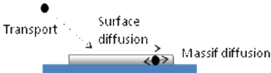
**Figure 2.2** Principales étapes de formation de dépôt sur le substrat
