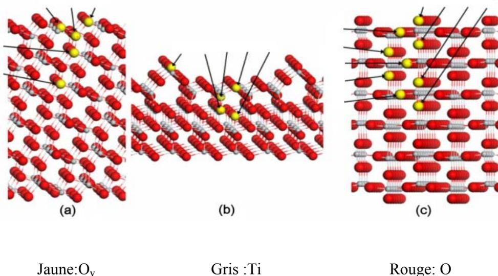
**Figure 1.8** a) Le plan (101) d'A- $TiO_2$     b) Le plan (001) d'A- $TiO_2$     c) Le plan (110) de R- $TiO_2$
