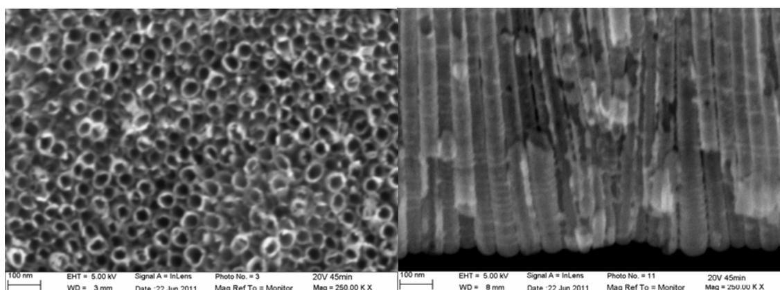
**Figure 3.11** Cliches de MEB de TiO<sub>2</sub>-NT(EG) 20V45min
