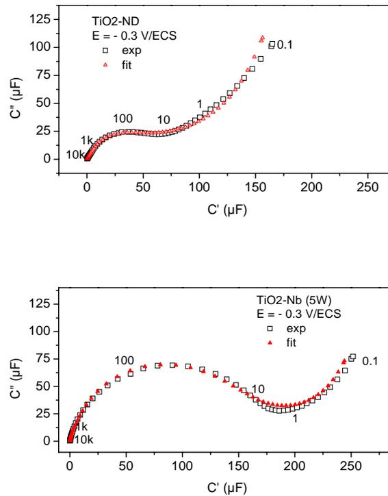
**Figure 2.15** Diagrammes d'impédance sous forme de capacités complexes pour l'échantillon  $\text{TiO}_2$  non dopé et l'échantillon  $\text{TiO}_2\text{-Nb}$  (5W) à  $-0,3\text{V}$ . Comparaison entre résultats expérimentaux et résultats simulés en utilisant le circuit équivalent de la figure 2.14.
