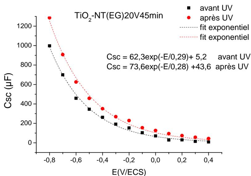
**Figure 5.12** Capacité équivalente de la zone de charge d'espace de la couche  $\text{TiO}_2\text{-NT(EG)20V45min}$  en milieu neutre (solution désaérée de  $\text{Na}_2\text{SO}_4$  à  $0.1 \text{ mol L}^{-1}$ )
