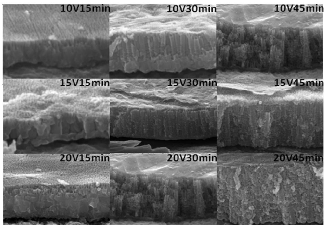
**Figure 3.9** Clichés MEB des séries de TiO<sub>2</sub> –NT(TB) obtenues par anodisation en mode potentiostatique à 3 potentiels et pour 3 durées d’anodisation différents.
