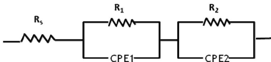
**Figure 7.4** Circuit équivalent de l'échantillon  $TiO_2\text{-NT}(TB)20V45min$  en milieu au milieu NaOH (pH=12,5) sous éclairement
