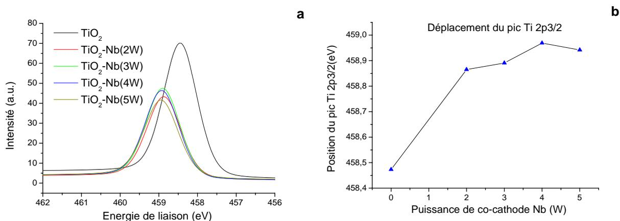
**Figure 2.6** Spectres XPS dans la région de l'énergie de liaison de Ti<sub>2p</sub> pour différentes conditions de co-dépôt (a) et évolution de la position du pic de Ti<sub>2p</sub> en fonction de la puissance appliquée au cours du dépôt de Nb (b).
