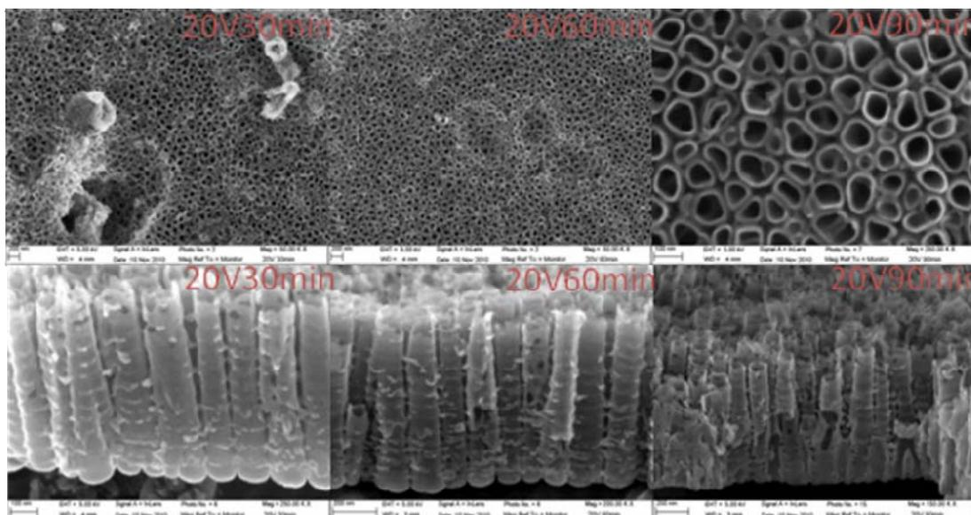
**Figure 3.12** Clichés MEB de couches de TiO<sub>2</sub> NT obtenues sur un dépôt de titane déposé sur le silicium (anodisation à 20V pendant différentes durées)
