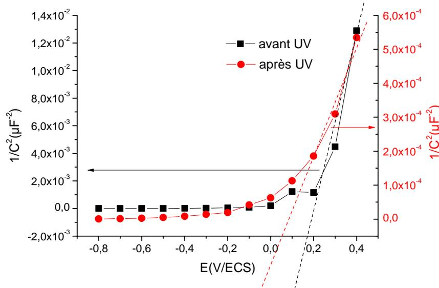
**Figure 5.13** Variation de  $1/C^2$  en fonction du potentiel pour la couche  $\text{TiO}_2\text{-NT (EG) 20V45min}$  en milieu neutre.
