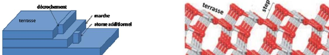
**Figure 1.10** a) Modèle de TLK (Terrace Ledge Kink) pour des défauts à échelle atomique b) Marches sur le plan (101) de A-TiO<sub>2</sub>
