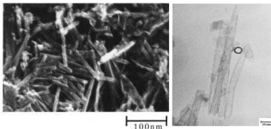
**Figure 3.2** Clichés de MEB (a) et MET (b) de nanotubes obtenus par le traitement de poudre TiO<sub>2</sub>:SiO<sub>2</sub> (4:1 en %mol) (Extrait de [21])
