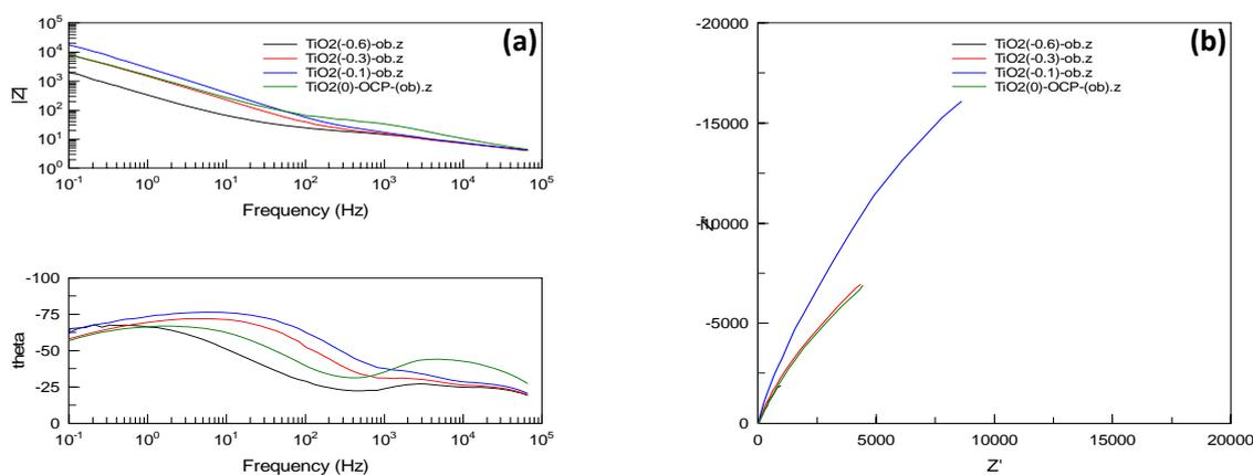
**Figure 2.13.** Diagrammes d'impédance en représentation de Bode **(a)** et de Nyquist **(b)** à l'obscurité pour  $\text{TiO}_2$  non dopé, en milieu  $\text{Na}_2\text{SO}_4$   $1 \text{ mol L}^{-1}$ , pour différents potentiels appliqués
