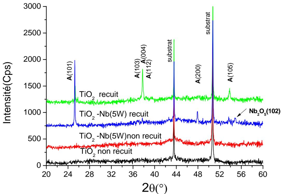
**Figure 2.10** Spectre de diffraction des rayons X des couches non dopée et dopée par Nb (5W) avant et après recuit à  $525^\circ\text{C}$
