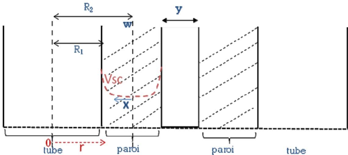
**Figure 4.2.** Vu latérale d'un tube montrant la forme de la charge d'espace dans une paroi.
