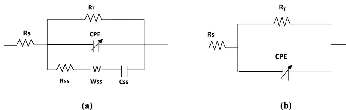
**Figure 5.5** Circuits équivalents (a) avant exposition UV pour les deux échantillons et après exposition UV pour la couche  $\text{TiO}_2\text{-comp15V15min}$  (b) après exposition UV pour la couche  $\text{TiO}_2\text{-NT (TB) 20V45min}$
