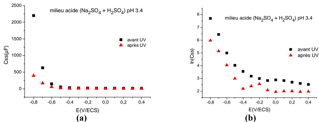
**Figure 6.14** Capacité de l'état de surface (a) et  $\ln(C_{ss})$  en fonction de potentiel appliqué(b) de la couche  $TiO_2$ -NT(TB)20V45min dans le milieu  $Na_2SO_4 + H_2SO_4$ (pH=3,5) à l'obscurité avant et après UV éclaircissement
