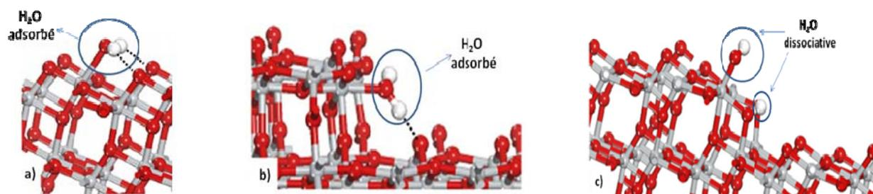
**Figure 1.12** a)  $H_2O$  adsorbé en mode non dissociatif sur une terrasse (101) b)  $H_2O$  adsorbé en mode non dissociatif sur une marche de type D c)  $H_2O$  adsorbé en mode dissociatif sur une marche de type B (Extrait de [33])
