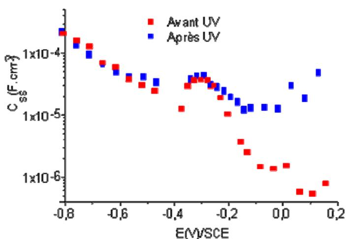
**Figure 1.7** Diagramme de  $\ln(C_{ss})$  d'une couche nanocolonnaire de TiO<sub>2</sub>, en fonction de potentiels appliqués à l'obscurité dans Na<sub>2</sub>SO<sub>4</sub> (1mol.L<sup>-1</sup>) et après éclaircissement UV
