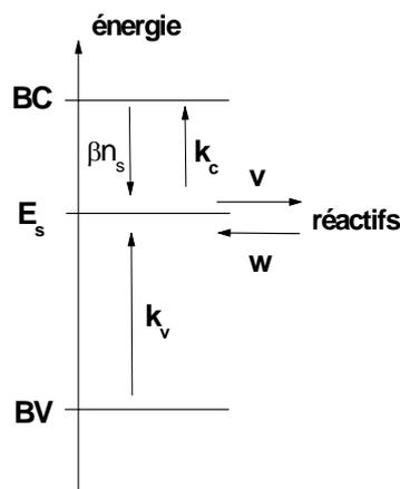
**Figure 7.8** Schéma réactionnel décrivant les échanges électroniques *via* un état de surface, d'après F. Cardon [12].
