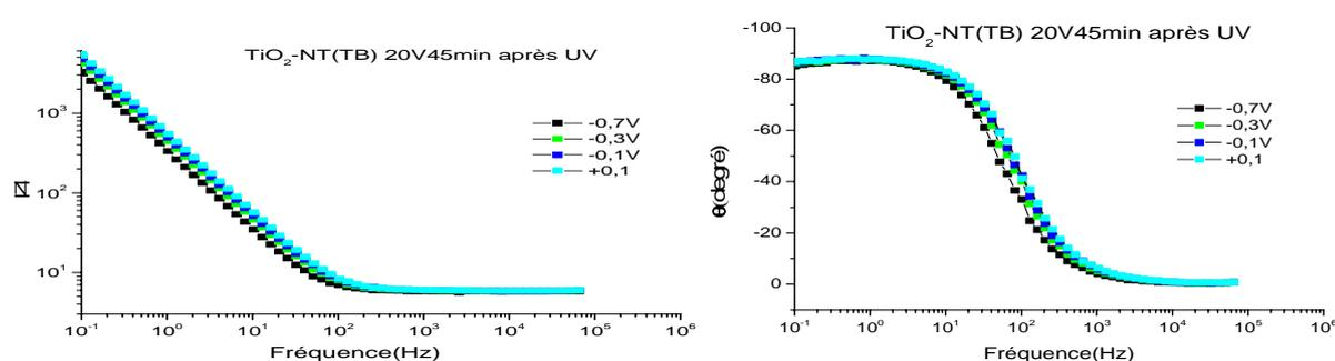
**Figure 5.4** Diagramme de Bode de la couche  $\text{TiO}_2\text{-NT(TB) 20V45min}$  à l'obscurité pour différents potentiels appliqués, après exposition UV dans la solution  $\text{Na}_2\text{SO}_4$  ( $1\text{ mol L}^{-1}$ ) désaérée.
