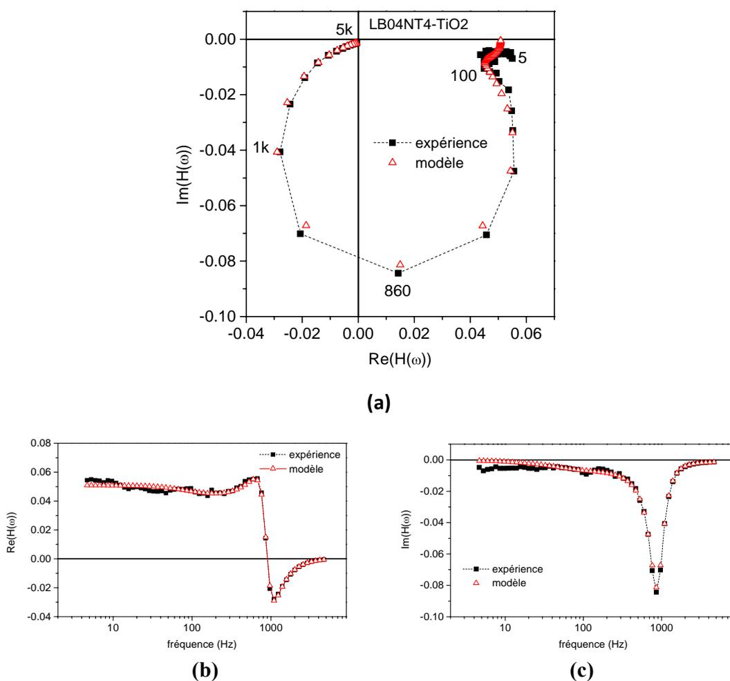
**Figure 7.7 :** Spectre IMPS (19 points/décade) dans les représentations de Nyquist(a) et de Bode (b et c) d'une couche nanotubulaire de  $TiO_2$  polarisée à +0,4 V/ (Ag/AgCl) dans une solution NaOH 0,1M+ 0,1M MeOH ; photocourant =  $0,3 \mu A$  sous éclairnement d'une lampe Xénon 150W correspondant à un flux de photons d'environ  $10^{14} \text{ cm}^{-2}\text{s}^{-1}$ .
