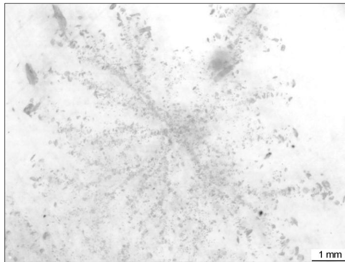
Figure 3.4 : développement en étoile de cavités pour un échantillon soumis à P_{sat} = 6 \text{ MPa} et V_d = 9 \text{ MPa/min} .
