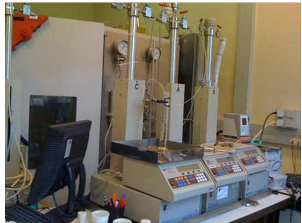
Figure 1: En haut: Schéma de principe du dispositif de Mesure Sous Contraintes. En bas: (à droite) photographie de la cellule triaxiale en place dans l'étuve; (à gauche) trois pompes permettant la régulation des pressions axiale, radiale (confinement) et de pore.
