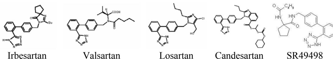
**Figure D - 35 : additifs de "type tailor-made" utilisés pour avoir un effet sur la croissance de l'Irbesartan forme A.**
