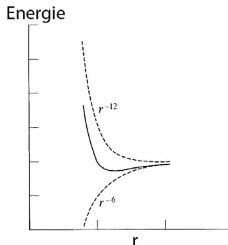
**Figure B - 20 : variation de l'énergie exprimée par le potentiel de type Lennard-Jones en fonction de la distance entre les atomes, et faisant apparaître la contribution répulsive en  $r^{-12}$  et la contribution attractive en  $r^{-6}$ .**
