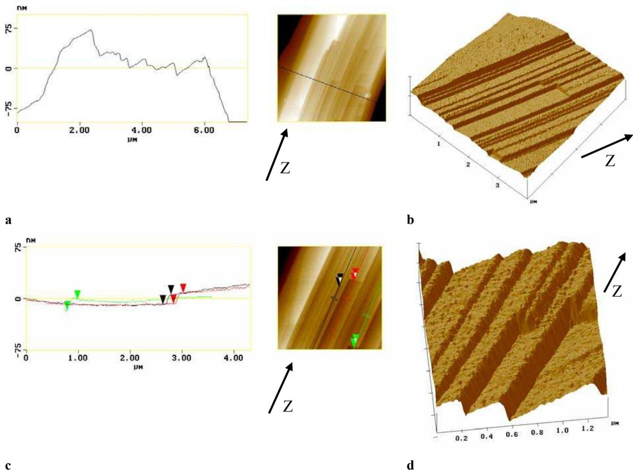
**Figure D - 21 : observations par AFM ex situ, des faces latérales des cristaux d'Irbesartan phase A obtenus à  $5^\circ\text{C}$ , a) section perpendiculairement à l'axe d'allongement du cristal (échelle dilatée en z), b) représentation tridimensionnelle des agglomérats de baguette, c) section colinéairement à l'axe d'allongement du cristal (échelle dilatée en z) et d) représentation tridimensionnelle des agglomérats de baguette.**
