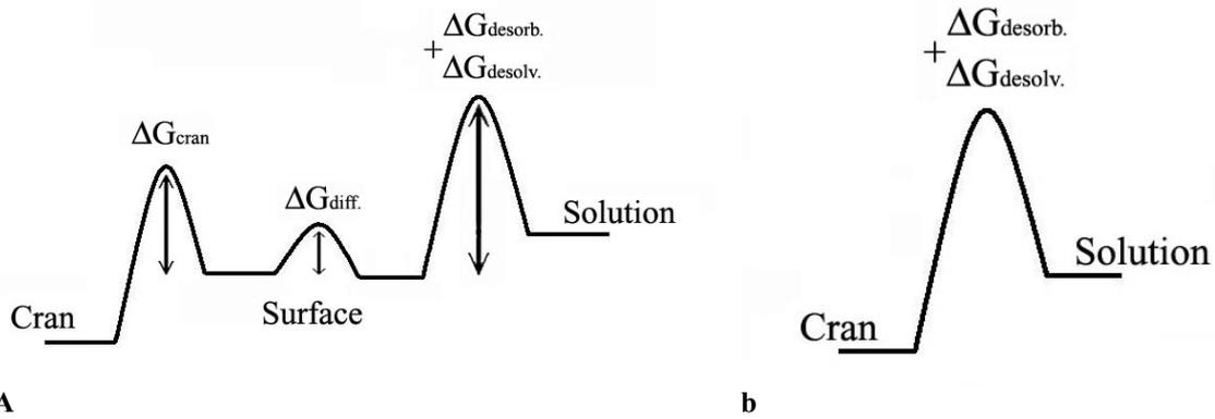
**Figure B - 8 : variation d'énergie libre associée à la diffusion d'une unité de croissance du volume de la solution vers le site de croissance a) dans le cas d'une face de type F, b) dans le cas d'une face de type S ou K [BEN69].**
