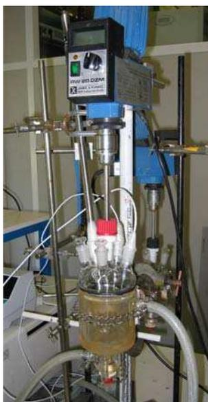
**Figure C - 8, Réacteur de cristallisation de 200 ml à double enveloppe réglée en température par un bain thermostaté.**
