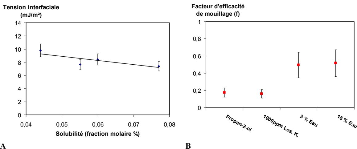
**Figure D - 28, a) évolution de la tension interfaciale en fonction de la solubilité (indépendamment du milieu de cristallisation) b) facteur d'efficacité de mouillage en fonction du milieu de cristallisation.**
