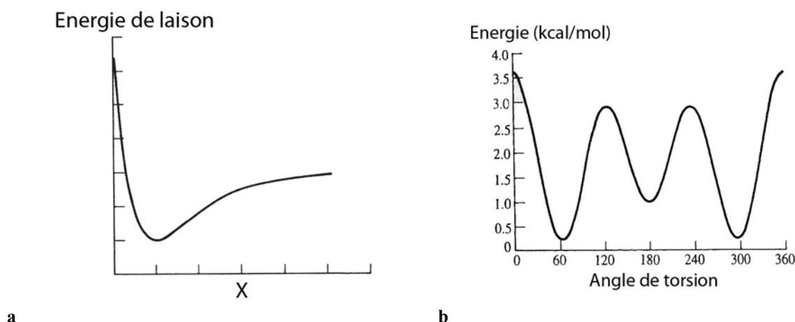
**Figure B - 18 : variation de l'énergie de la liaison en fonction de la position des atomes constitutifs, a) pour un potentiel harmonique (élongation et mouvements angulaires) et b) pour une rotation autour de la liaison (exemple de la liaison O-C-C-O de la molécule C<sub>2</sub>H<sub>4</sub>O<sub>2</sub>).**
