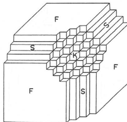
**Figure B - 6 : Classification des faces du cristal en fonction de la géométrie des sites d'adsorption pour un cristal de Kossel dont l'unité de croissance est de forme cubique, face de type F (flat), S (stepped) et K (kinked).**
