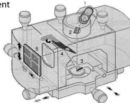
Figure C - 4 : représentation de la "tête" de l'AFM montrant le fonctionnement de la mesure de la topographie.
