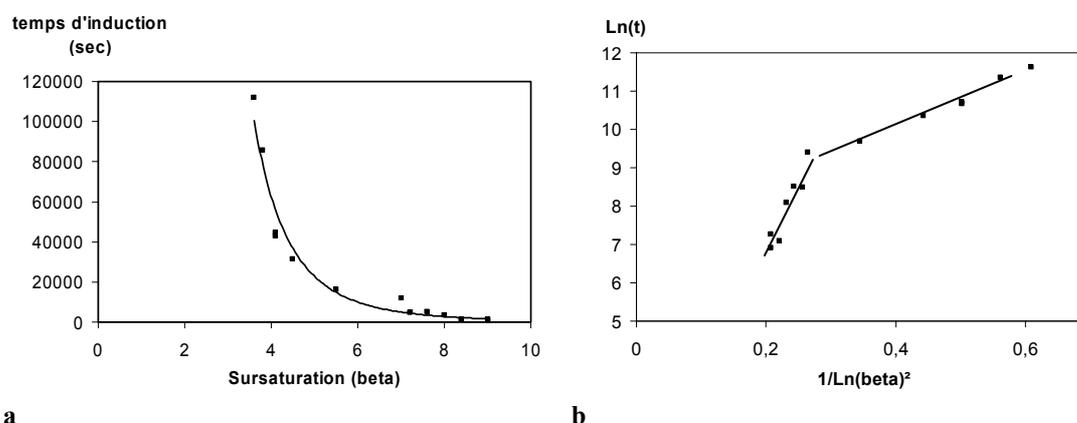
**Figure D - 14, a) évolution du temps d'induction (sec.) en fonction de la sursaturation à 20°C dans le Propan-2-ol, b) évolution du logarithme népérien du temps d'induction (seconde) en fonction du logarithme népérien de la sursaturation à la puissance -2, à 20°C dans le Propan-2-ol et à une vitesse d'agitation de 300tr/min.**
