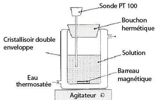
Schéma C - 3 : Cellule thermostatée à double enveloppe
