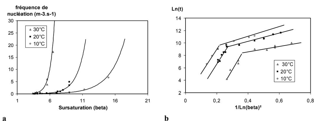
**Figure D - 15, a) fréquences de nucléation primaire en fonction de la sursaturation, à 10, 20 et 30°C dans le Propan-2-ol et à une vitesse d'agitation de 300tr/min. b) évolution du logarithme népérien du temps d'induction (secondes) en fonction du logarithme népérien de la sursaturation à la puissance -2, à 10, 20 et 30°C dans le Propan-2-ol et à une vitesse d'agitation de 300tr/min.**
