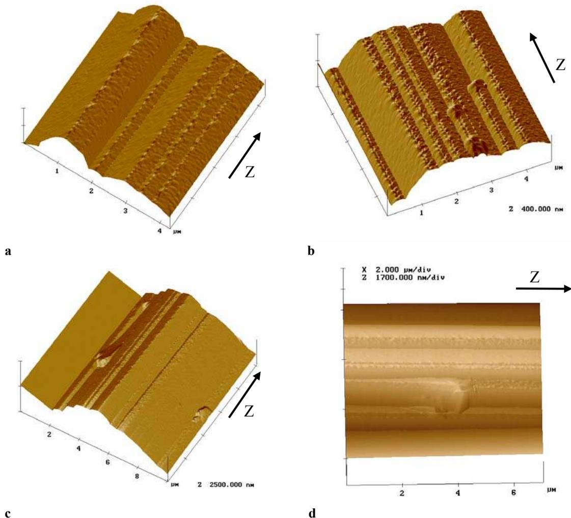
**Figure D - 22 : observations par AFM ex situ, des faces latérales des cristaux d'Irbesartan phase A obtenus à 2°C, représentation tridimensionnelle des agglomérats de baguettes a) présence de faces vicinales, b) micro-cristaux croissant de manière orientée par rapport au cristal parent, c) et d) micro-cristal perdant son orientation par rapport au cristal parent entraînant la formation d'un cristal indépendant**
