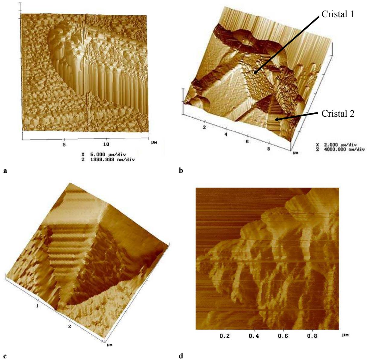
**Figure D - 32 : observation par AFM ex situ, des faces terminales des cristaux d'Irbesartan phase A obtenus à 20°C dans une solution de Propan-2-ol/eau (31/69), les aiguilles observées ont nucléé ou se sont agglomérées et ont cru sur des cristaux de la phase B, a) représentation tridimensionnelle de la topographie d'une aiguille et du support, b) image d'agglomérat de cristaux, c) et d) représentation tridimensionnelle des faces terminales.**
