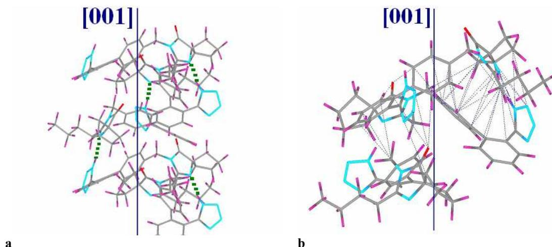
**Figure D - 8 : a) liaisons intermoléculaires de type Hydrogène représentées en pointillé à l'intérieur du cristal d'Irbesartan forme A, projection colinéaire à la direction [001]. b) liaisons intermoléculaires de type van der Waals et coulombienne représentées en pointillé à l'intérieur du cristal d'Irbesartan forme A, projection dans un plan parallèle à la direction [001].**
