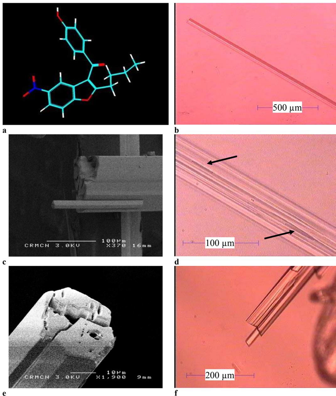
**Figure D - 24 :** a) formule chimique de la molécule de SR28043, images en microscopie optique des cristaux de SR28043 forme A dans une solution d'éthanol, b) à l'équilibre à 23°C, d) et f) après croissance, c) et e) images en microscopie électronique à balayage des cristaux obtenus dans les mêmes conditions.
