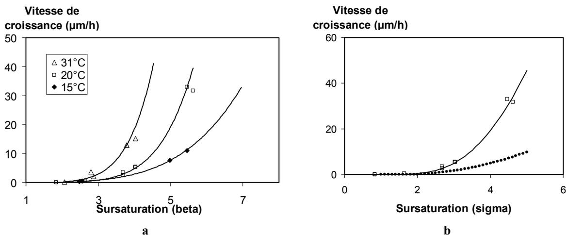
Figure D - 18, a) vitesse de croissance des faces terminales en fonction de la sursaturation ( $\beta$ ) pour des températures de 15, 20 et 31°C, b) test de croissance pour une croissance de type spirale (modèle BCF modifié [CAB58] limitée par la diffusion de surface) courbe en pointillé et modèle par germination bidimensionnelle (modèle Birth and Spread) courbe en ligne pleine pour la croissance à 20°C.
