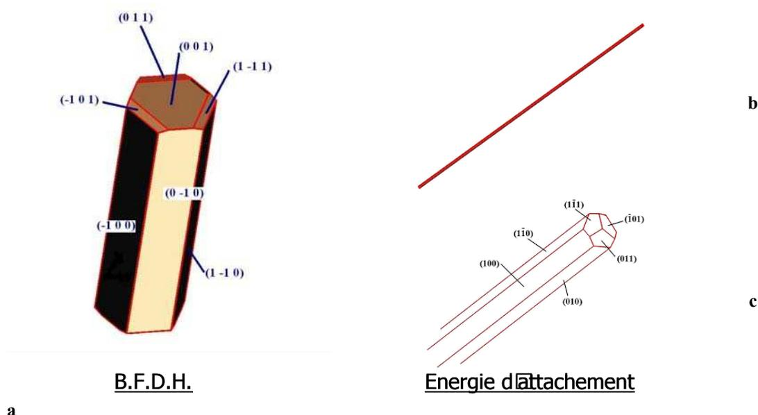
**Figure D - 9 : Morphologie et faciès des cristaux d'Irbesartan forme A, prédites par modélisation a) modèle BFDH, b) modèle des énergies d'attachement, c) agrandissement du cristal obtenu par le modèle des énergies d'attachement.**
