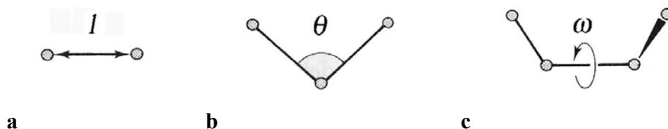
**Figure B - 17 : représentation schématique des contributions intramoléculaires prises en compte en mécanique moléculaire. a) élongation de la liaison, b) variation angulaire et c) rotation autour de la liaison.**
