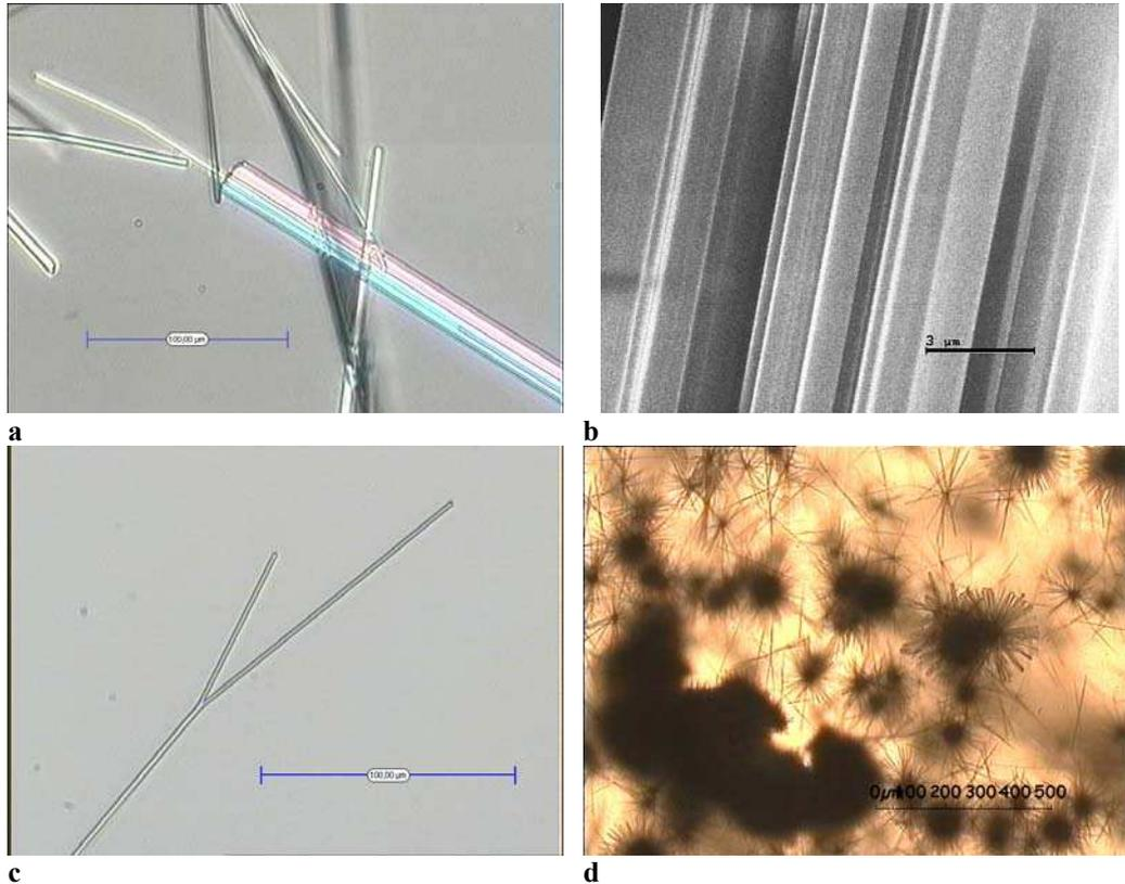
**Figure D - 23 : images d'agglomérats de cristaux d'Irbesartan phase A ayant cru en gardant la même orientation cristallographique, a) en microscopie optique à transmission, b) en microscopie électronique à balayage et images en microscopie optique à transmission de cristaux ayant perdu cette orientation cristallographique c) formant des fourches et d) formant des sphérolites.**
