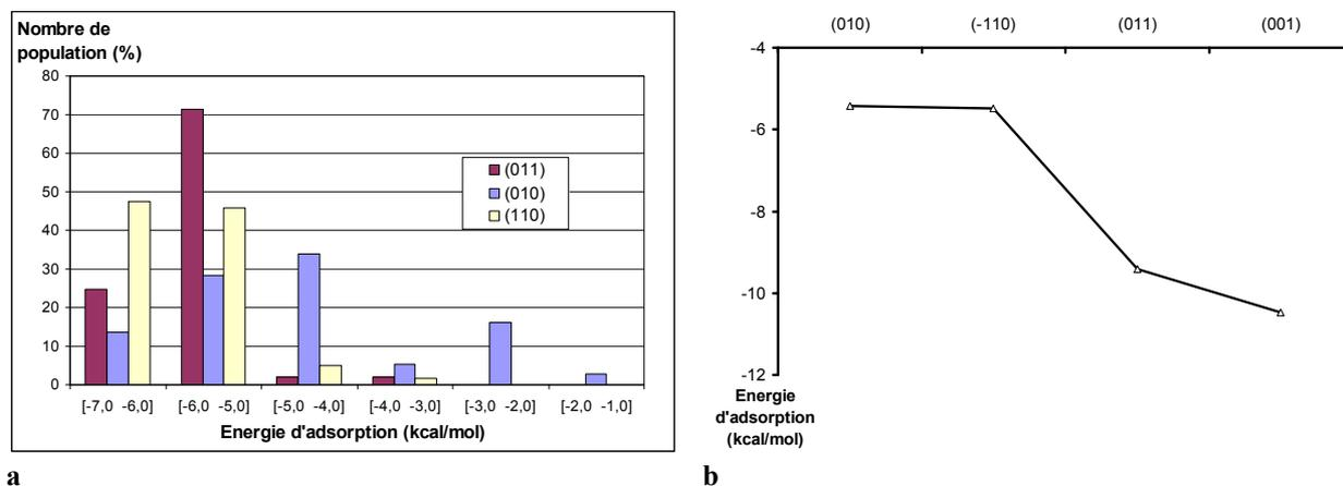
**Figure D - 12 : Adsorption d'une molécule de solvant (Propan-2-ol) sur des faces terminales et des faces latérales du cristal théorique a) premier module de "Docking", les énergies d'adsorption sont réparties par classe énergétique, b) second module de "Docking" énergie d'adsorption sur le site le plus énergétique de la face considérée, les énergies calculées sont des approximations et ne correspondent pas aux valeurs exactes calculées par le champ de force).**
