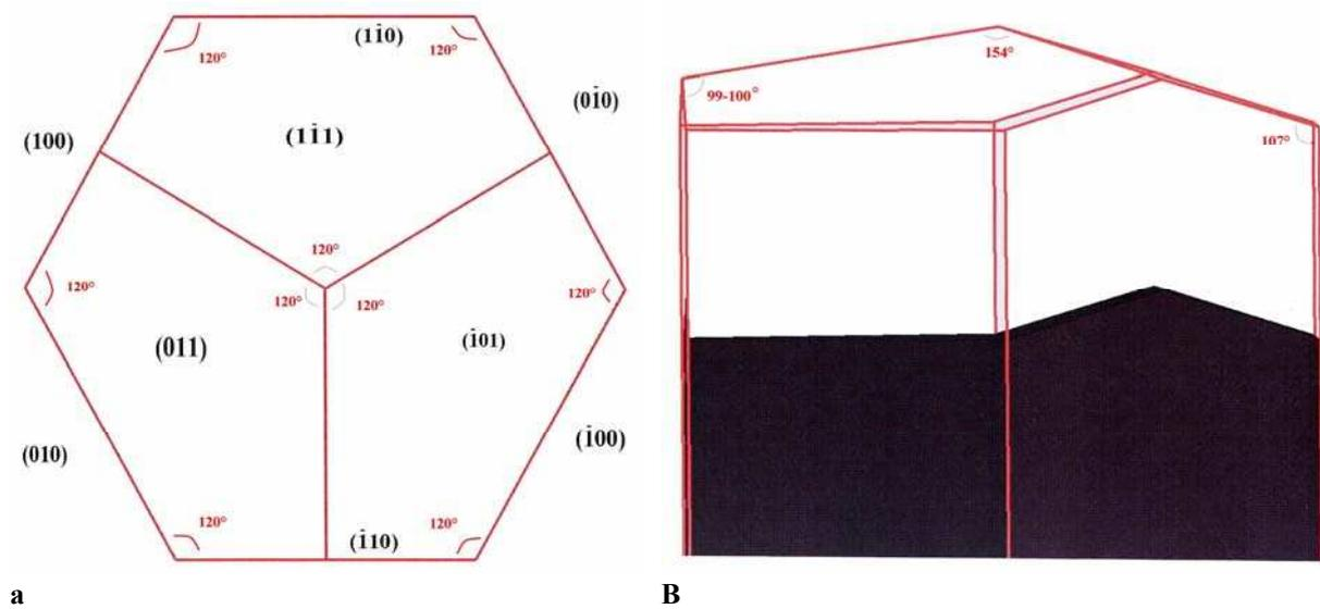
Annexe 4 : angles entres les faces du cristal prédit par le modèle des énergies d'attachement a) suivant le plan (001) et b) suivant le plan (110).
