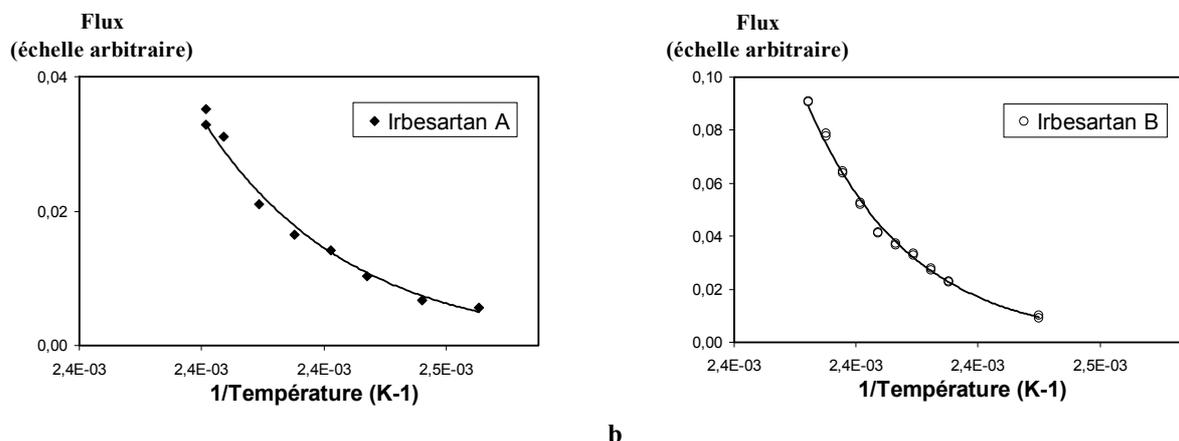
**Figure D - 10 : flux obtenue lors de la sublimation de cristaux d'Irbesartan en fonction de l'inverse de la température en Kelvin a) pour la phase A, b) pour la phase B. Les courbes sont des ajustements exponentiels.**
