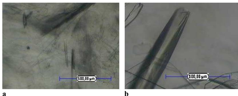
**Figure D - 29 : cristaux obtenus avec 7000 ppm de méthionine dans une solution à 20% (massique) en eau / Propan-2-ol et une concentration en Irbesartan de 16,7 g/L<sub>solv.</sub> à 20°C.**
