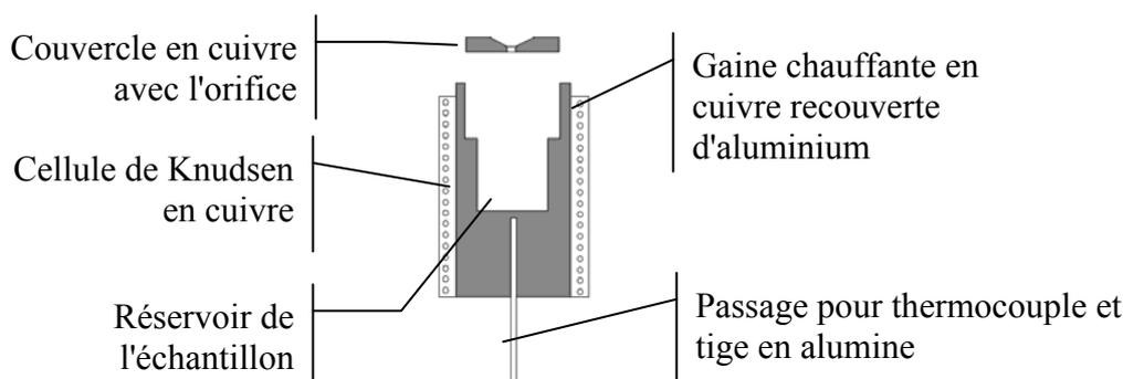
**Schéma C - 2 : montage expérimental utilisé, montrant la cellule de Knudsen et la partie chauffante.**
