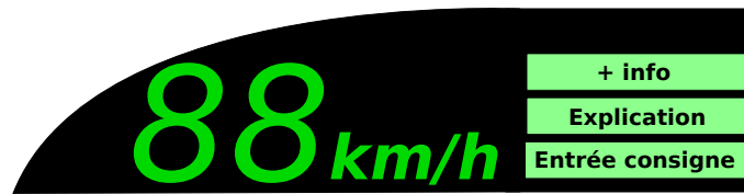
FIG. 5.5 : Exemple d'interface pour un régulateur de vitesse. La vitesse instantanée est affichée en vert. On retrouve, sur le côté droit, trois boutons qui permettent (de haut en bas) d'accéder à des informations complémentaires sur la vitesse, de demander une explication et de saisir une consigne. Les informations complémentaires et les explications viendraient s'afficher en lieu et place de la vitesse de façon temporaire.
