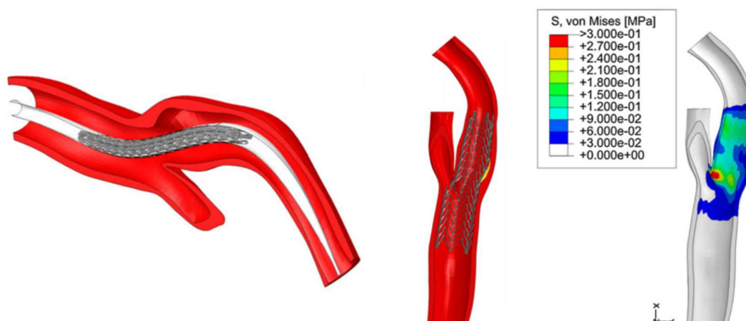
Figure 1.35 : Simulation du déploiement d'un stent dans une artère carotide et répartition des contraintes qu'appliquent le stent sur la paroi artérielle (Auricchio et al. , 2011)
