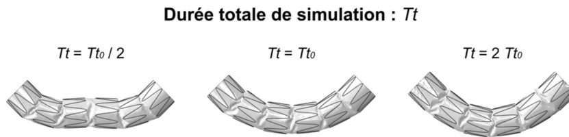
Figure 2.11 : Influence de la durée totale de simulation Tt sur les déformées des EPs
