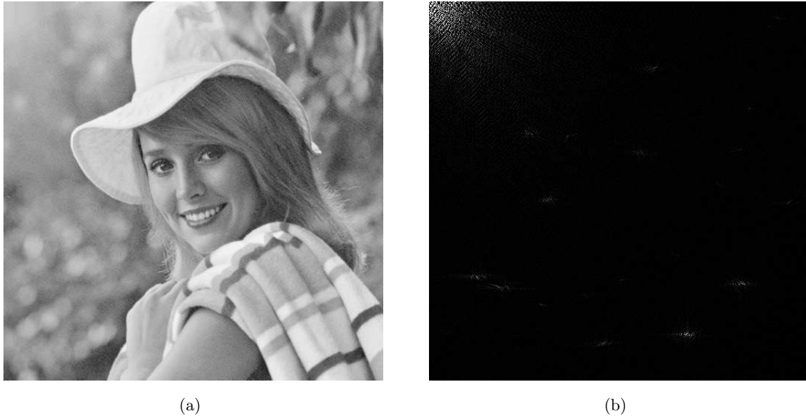
FIG. 3.5: Représentation d'une image codée sur 256 niveaux de gris (a) dans le domaine fréquentiel (b) grâce à l'application de la DCT 2D. Les composantes fréquentielles d'amplitudes élevées (respectivement de faibles amplitudes) sont signalées par des pixels dont la couleur tend vers le blanc (respectivement le noir). Ainsi, on observe que l'énergie de l'image est principalement portée par les basses fréquences représentées en haut et à gauche de la seconde image.
