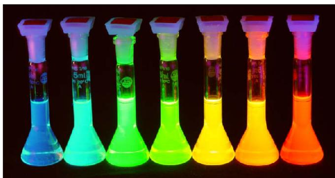
FIGURE 1.1 – Photoluminescence de solutions colloïdales de nanocristaux CdSe/ZnS de plusieurs tailles. Les particules les plus petites (1,7 nm) émettent dans le bleu, les plus grandes (5 nm) dans le rouge [Talapin 10].
