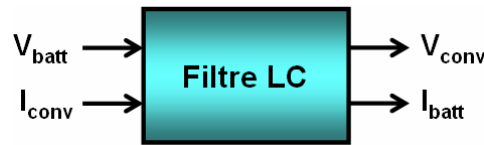
Figure 2.46 : Entrées-Sorties du modèle de filtre LC
