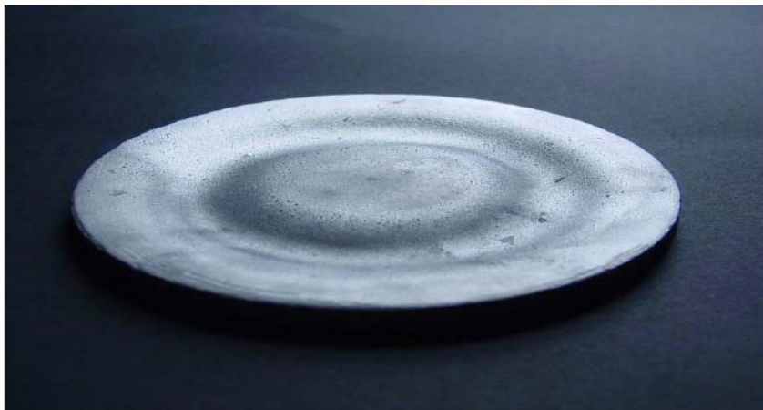
Figure 5.5 : Photo montrant une usure non uniforme d'une cible utilisée dans une configuration magnétron circulaire.
