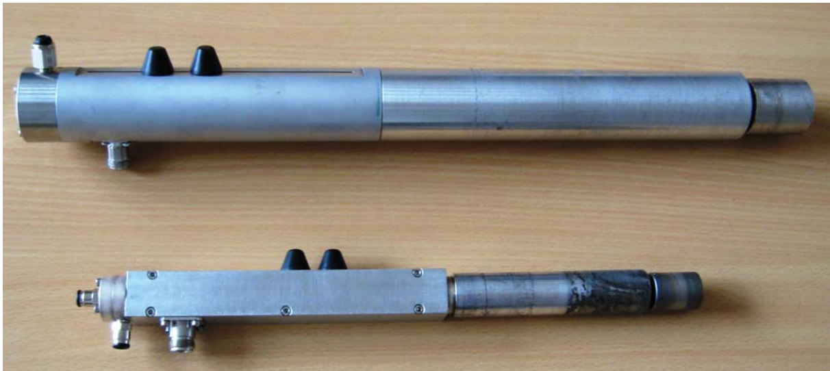
Figure 2.2 : Photo comparant une source élémentaire standard (bas) et une source élémentaire de génération 2 (haut).
