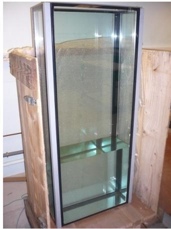
FIGURE 2.12 – Photo de la première cellule en double vitrage.
