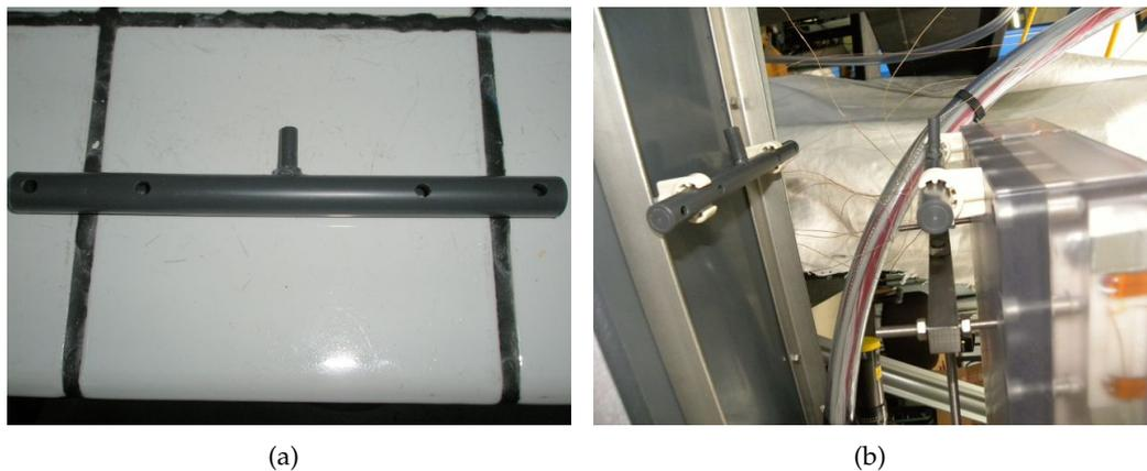
FIGURE 2.9 – (a) Photo d'un des diffuseurs en PVC utilisé pour l'aspiration et le refoulement du système de régulation. (b) Photo des diffuseurs d'aspiration (à gauche) et de refoulement (à droite) fixés sur la plaque support en PVC et sur le bloc paroi.
