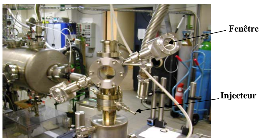
Figure II.1.10 Photographie de la pièce permettant le passage des lasers dans l'écoulement et des photons émis vers le système optique
