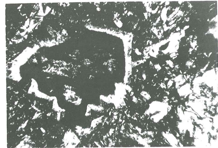
Photog. 20 : trachyandésite dont les plagioclases montrent deux stades d'accroissement (altéré au centre, frais en bordure). Ech. C 2 - 157 LP x 50
