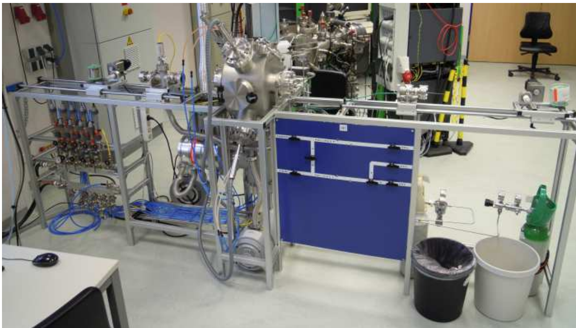
Figure 3-9 : Photographie du prototype de dépôt. Ici les systèmes de pompage différentiels ne sont pas montés sur la chambre de dépôt
