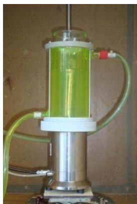
Figure 9 : Réacteur cup-horn 20 kHz avec double-enveloppe en verre pour refroidir la solution
