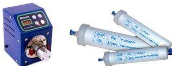
Figure 63 : Matériel de purification flash utilisé (Minibox + colonnes flash)
