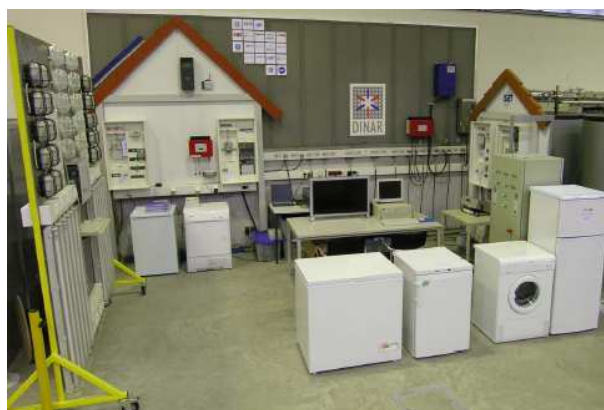
Figure II-5: Site de test DoMoTec d'un logement [BRAU, 09]
