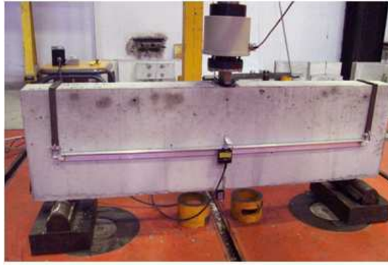
Figure 2-3: Dispositif d'essai de flexion trois points
