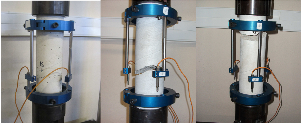
Figure 5-8: Localisation de la macro-fissure dans les éprouvettes de béton testées en traction directe.
