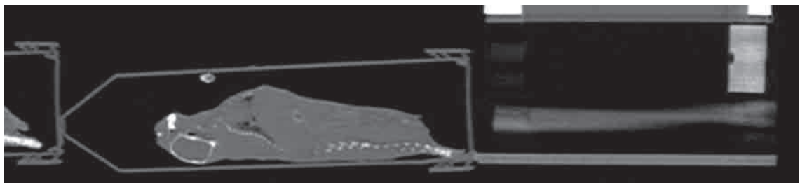
FIGURE 9.5 – Zoom sur la vue de profil d'une l'acquisition permettant de distinguer la souris à l'intérieur du tube et l'objet de test derrière ce tube
