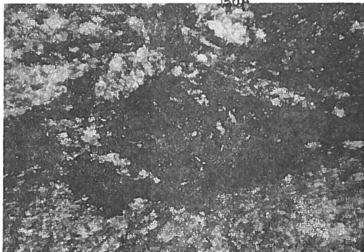
22 - Filonnet hydrothermal de chlorite isotrope dans un calcaire métamorphisé (LP)
