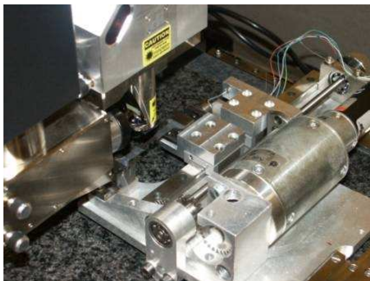
Fig. III.1 – Machine de traction in situ placé dans le microscope
