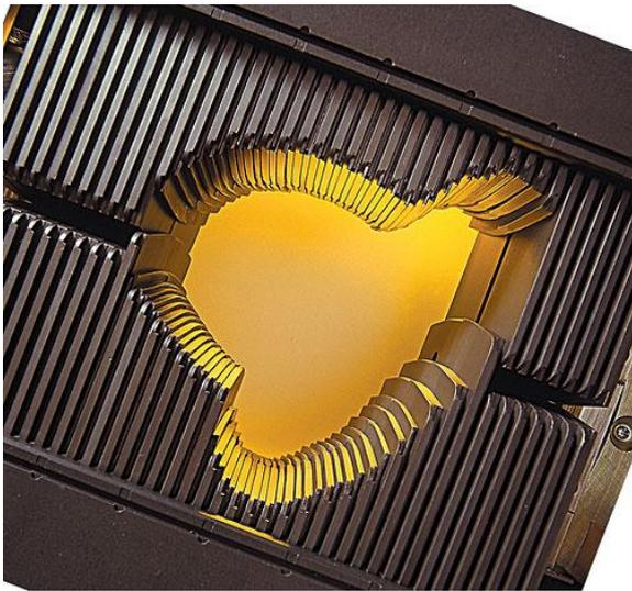
Figure 1: Un collimateur multi-lames<sup>5</sup>.
