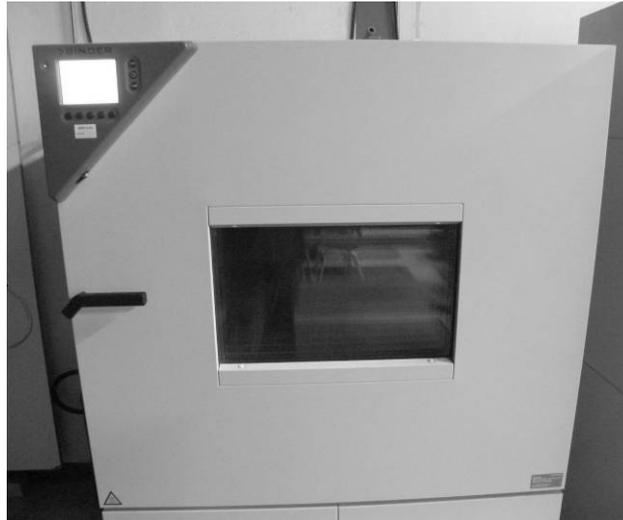
Figure 2.26 : Vue de l'enceinte Binder utilisée pour la préparation des échantillons fissurés par des cycles de gel-dégel.
