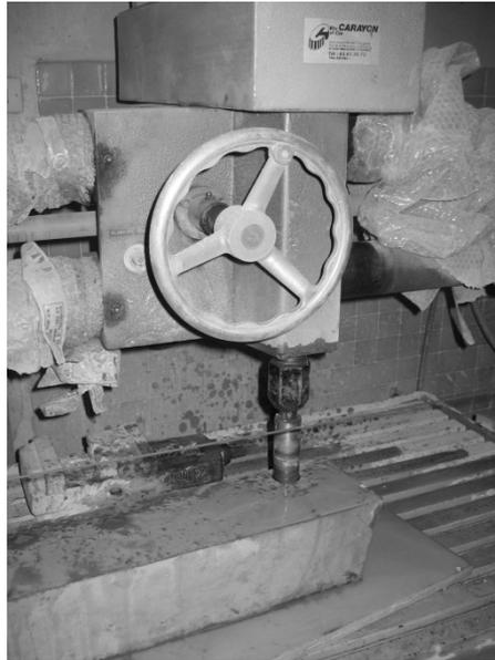
Figure 2.5 : Carottage des échantillons.
