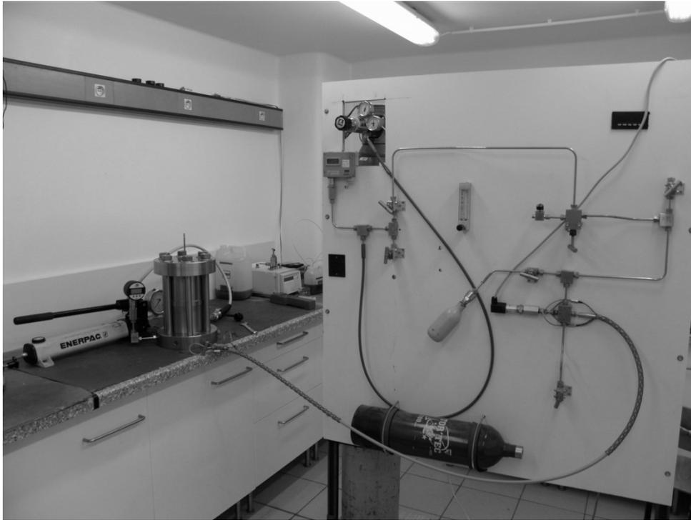
Figure 2.17 : Dispositif de mesure de la perméabilité au gaz en régime permanent sous température élevée.
