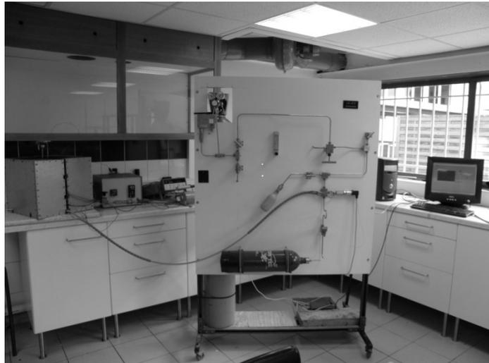
Figure 2.19 : Dispositif de mesure de perméabilité en ambiance chaude.
