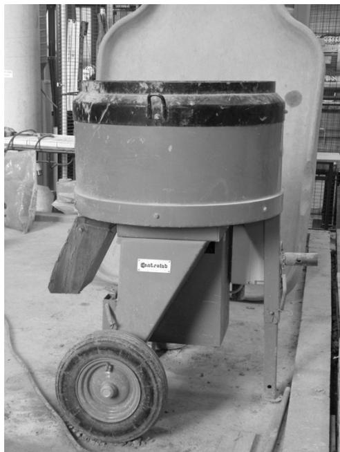
Figure 2.1 : Malaxeur pour la fabrication.
