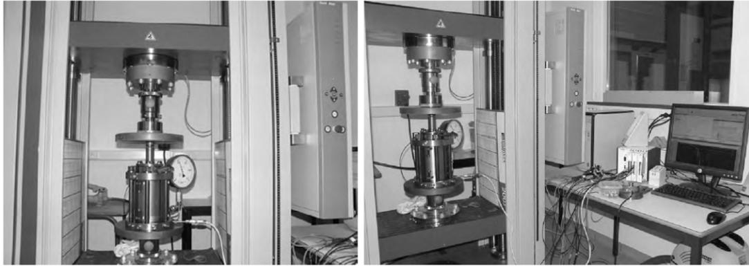
Figure 2.33 : Photos de la cellule triaxiale mise en place sur la presse mécanique Zwick<sup>®</sup>, avec l'acquisition Labview<sup>®</sup>.
