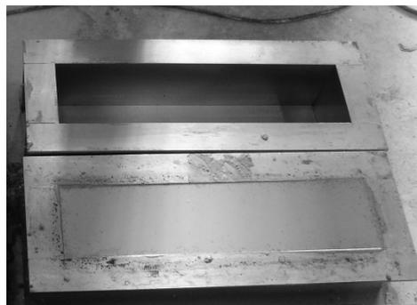
Figure 2.2 : Moule métallique pour former des poutres.
