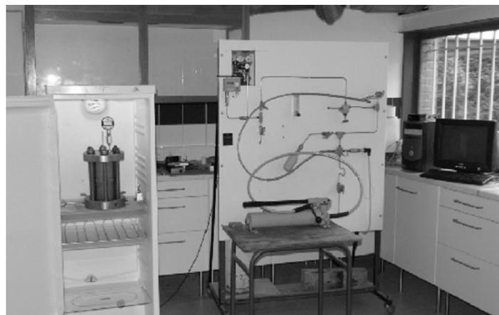
Figure 2.18 : Dispositif de mesure de perméabilité en ambiance froide.
