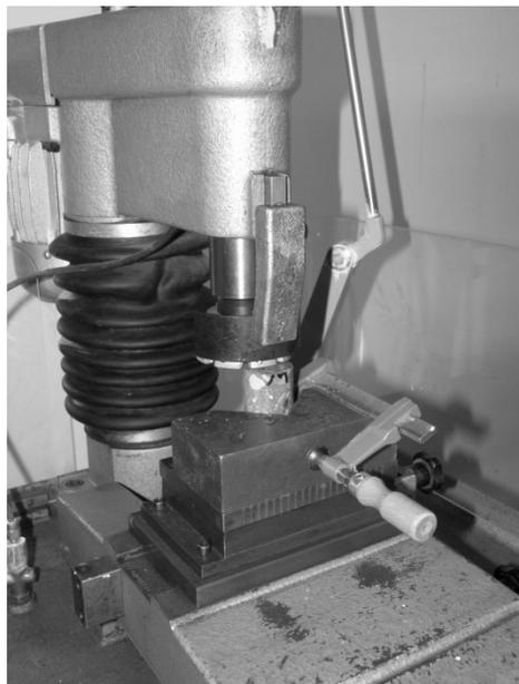
Figure 2.7 : Rectification des échantillons.
