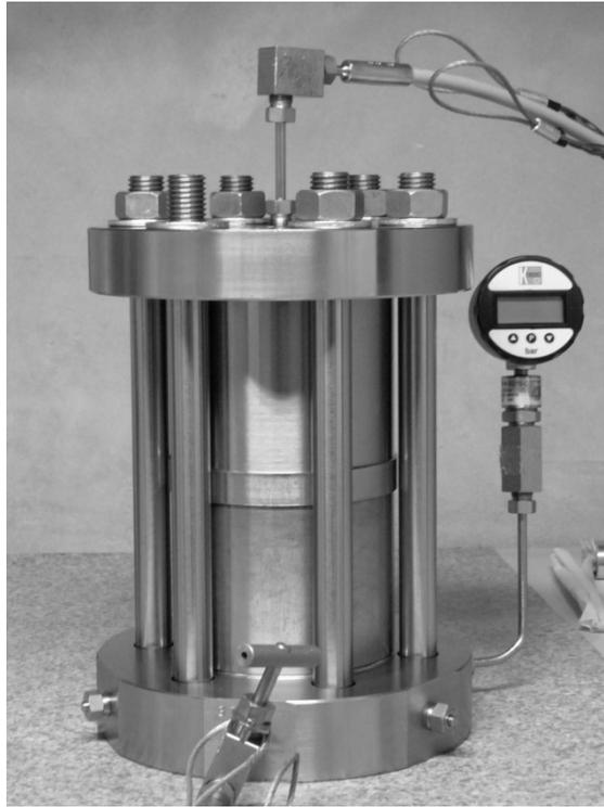
Figure 2.10 : Cellule hydrostatique.
