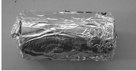
Figure 2.28 : Echantillon enveloppé d'un film aluminium.
