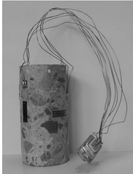
Figure 2.29 : Echantillon instrumenté de jauges de déformation et de la prise de câblage.
