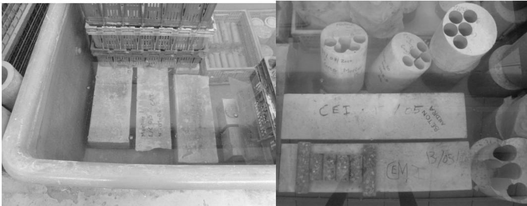
Figure 2.4 : Poutres en cure à l’eau (20°C±2°C).
