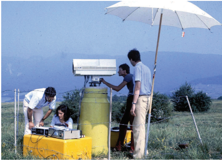
FIG. 2.17 – Mesures sur l'un des points du réseau géodésique du LEP
