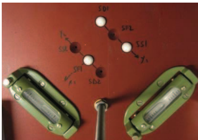
FIG. 3.16 – Repères de centrage du banc de calibration
