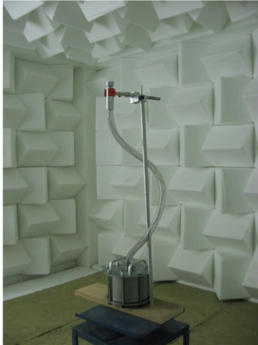
FIGURE 6.6 – Chambre de compression simulant un monopôle acoustique
